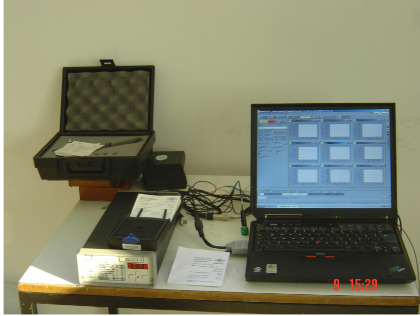
Şekil 6.5 Kullanılan bilgisayar ve sinyal şartlandırıcı
