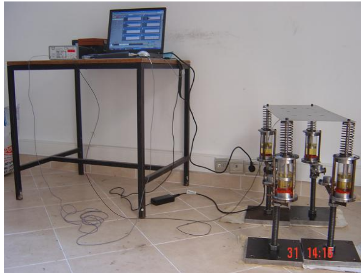
Şekil 6.33 Viskoelastik mesnetli plak sistemi
