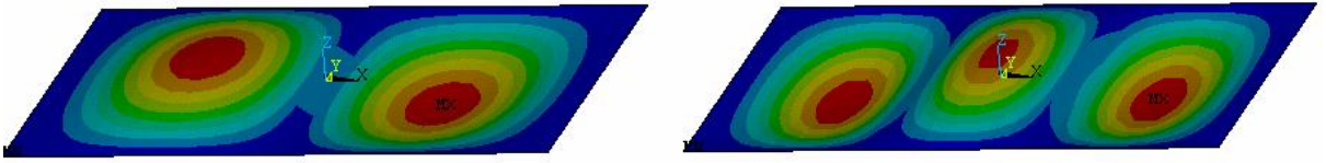
Şekil 3.7 Dört kenarı boyunca mesnetlenmiş plağın 1. AS modu ve 2. SS modu
