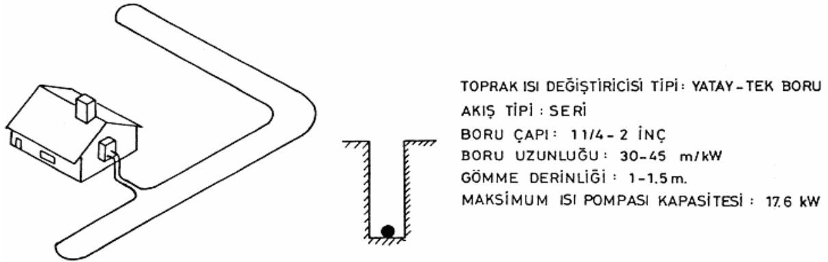
řekil 2.8 Seri akıř yollu, yatay toprak ısı deęiřtiricisi
