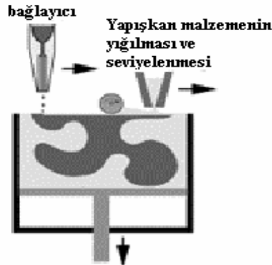
Şekil 2.27. MIT ‘nin geliştirdiği 3 boyutlu baskı tekniği [31]
