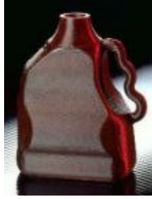
Şekil 2.21. FDM yöntemiyle hassas döküm mumu kullanılarak üretilmiş ince cidarlı bir şişe.
