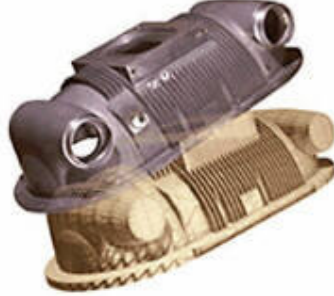
Şekil 2.26. LOM yöntemiyle üretilmiş bir dişli kutusu [16]
