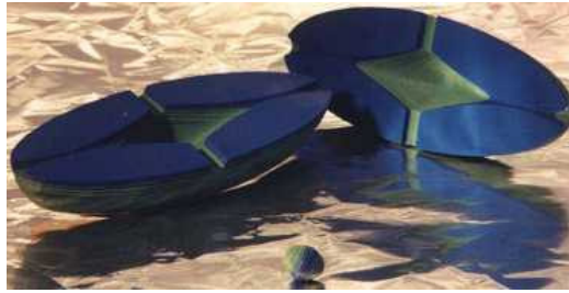
Şekil 2.34. Offset – Fabbing yöntemiyle üretilen bir parça [33]
