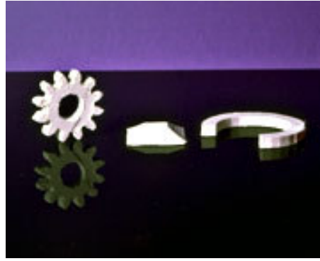
Şekil 2.23. FDM teknolojisiyle üretilen seramik parçalar [17]
