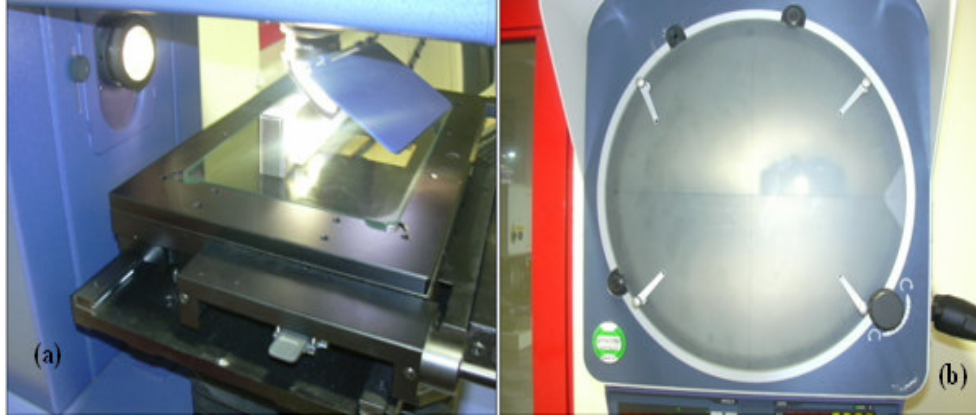
Şekil 4.6. (a) Ölçüm için tezgah tablasına yerleşim (b) Ekrandaki ölçüm için oluşan görüntü
