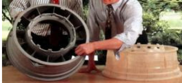
Şekil 2.41. Hassas dökümle üretilen bir jet motoru parçası (solda) ve bu parçanın kullanılan SLA modeli [17]
