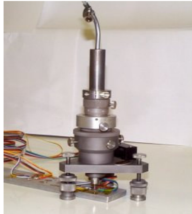
Şekil 3.6. Tipik bir delik delme cihazı [9]
