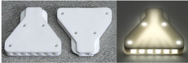
Şekil 2.32. CAM-LEM yöntemiyle üretilmiş bir parça [32]
