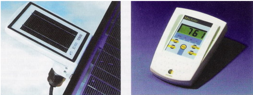
Şekil 2.12 PV sensörlü radyasyon ölçerler (German SES, 2005)
