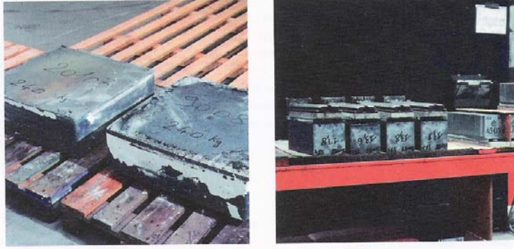
Şekil 3.6 Çok kristalli silikon bloklar (solda) ve kesilmiş çok kristalli silikon çubuklar (sağda) (German SES, 2005)
