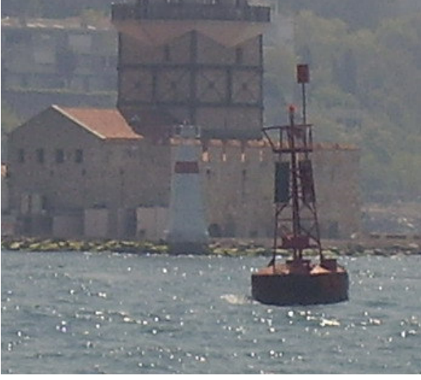
Şekil 6.15 Güneş pili kullanan duba ve ikaz feneri
