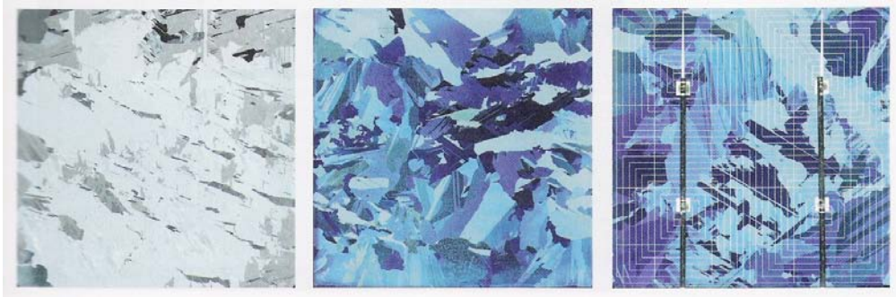
Şekil 3.7 Kaplamasız çok kristalli silikon pil (ortada), yansıma önleyici kaplanmış çok kristalli silikon pil (ortada) ve elektrik devreleri eklenmiş çok kristalli silisyum pil (sağda) (German SES, 2005)
