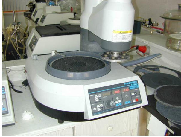
Şekil 3.6 Zımpara ve parlatma tezgahı
