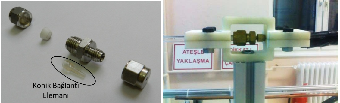
Şekil 3.12 (a) Kılcal boru bağlantı aparatının patlatılmış fotoğrafı ; (b) Bağlantı aparatının deney düzeneğine bağlanmış haldeki görüntüsü
