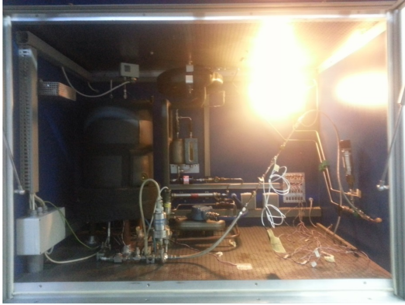
Şekil 3.40 Deney düzeneğine bağlanacak dinamik basınçölçerlerin kalorimetre üzerinde bulunan kalibrasyonlu basınçölçerler ile doğrulanması
