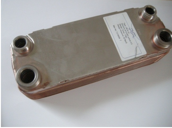
řekil 3.22 (a) Lehimli plakalı ısı deęiřtiricisinin fotoęrafı; (b) ısı deęiřtiricilerinin deney düzeneęine baęlı haldeki görüntüřü
