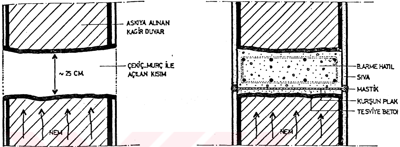
Bodrum Tepecik Çarili'nde Nemin Kesilmesi İçin Yapılan Uygulama.
