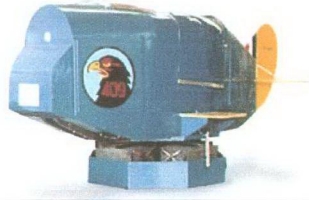
Şekil 2.2 İlk uçuş simulatörü Mavi Kutu'nun bir başka modeli. http://www.hangarline.com/bluebox409.jpg
