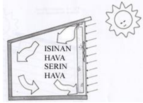
Şekil 3.19 Kesit, trombe duvarı ile iç mekanın ısıtılması (Fisk ve Anderson, 1982)
