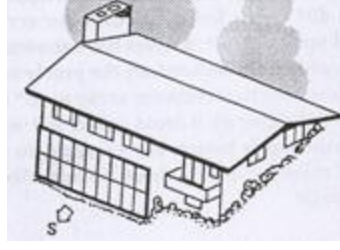
Şekil 3.31 Güney cephesinde yapıdan alt kote yerleştirilen güneş kolektörleri (Fisk ve Anderson, 1982)
