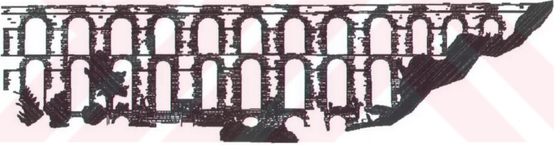
Şekil 5.7 Fotogrametrik yöntemle elde edilen Eğrikemer batı cephesinin bir bölümü
