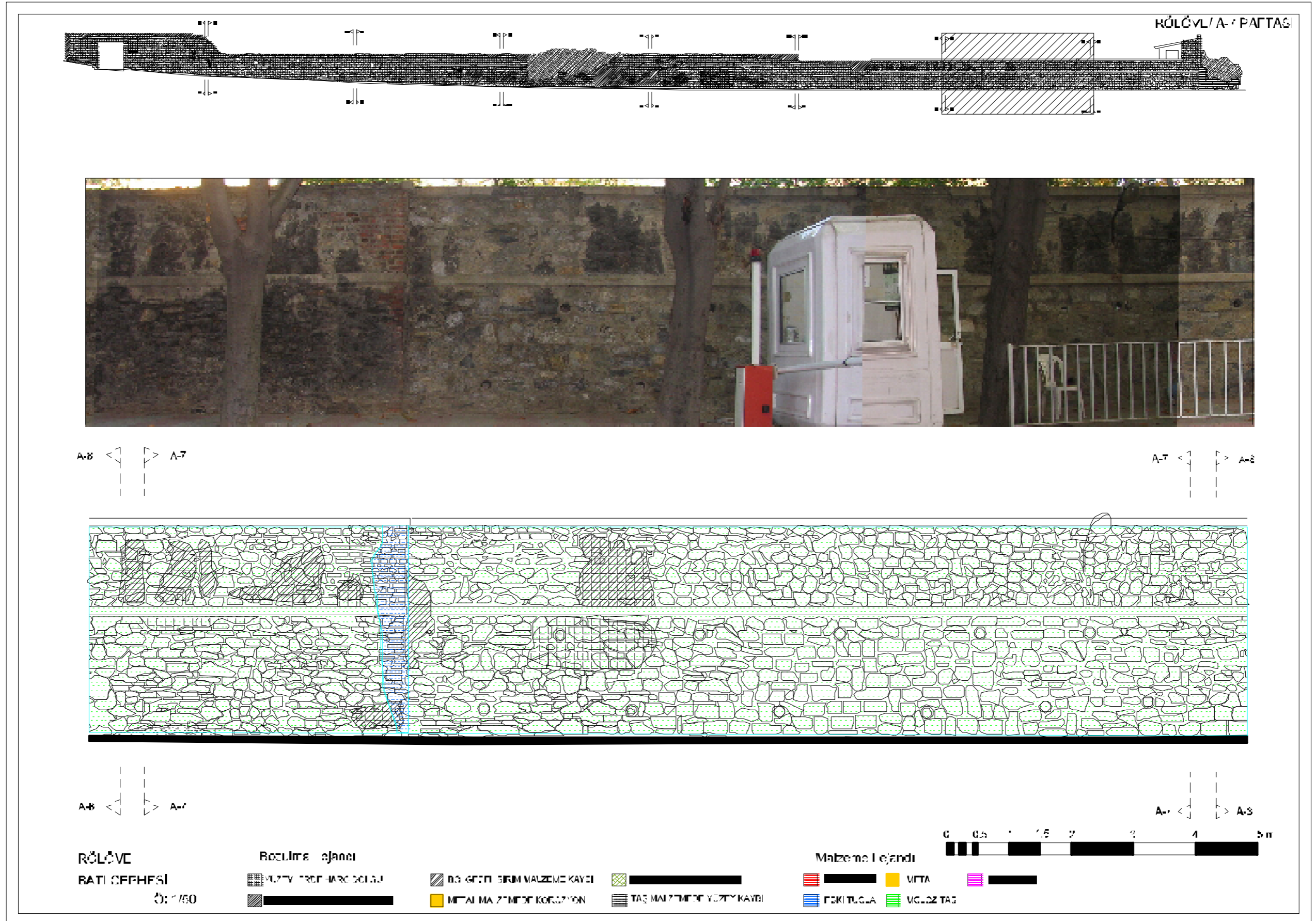
Şekil 4.32 Batı Duvarı, Batı Cephesi Röllöve A-7 Paftası
