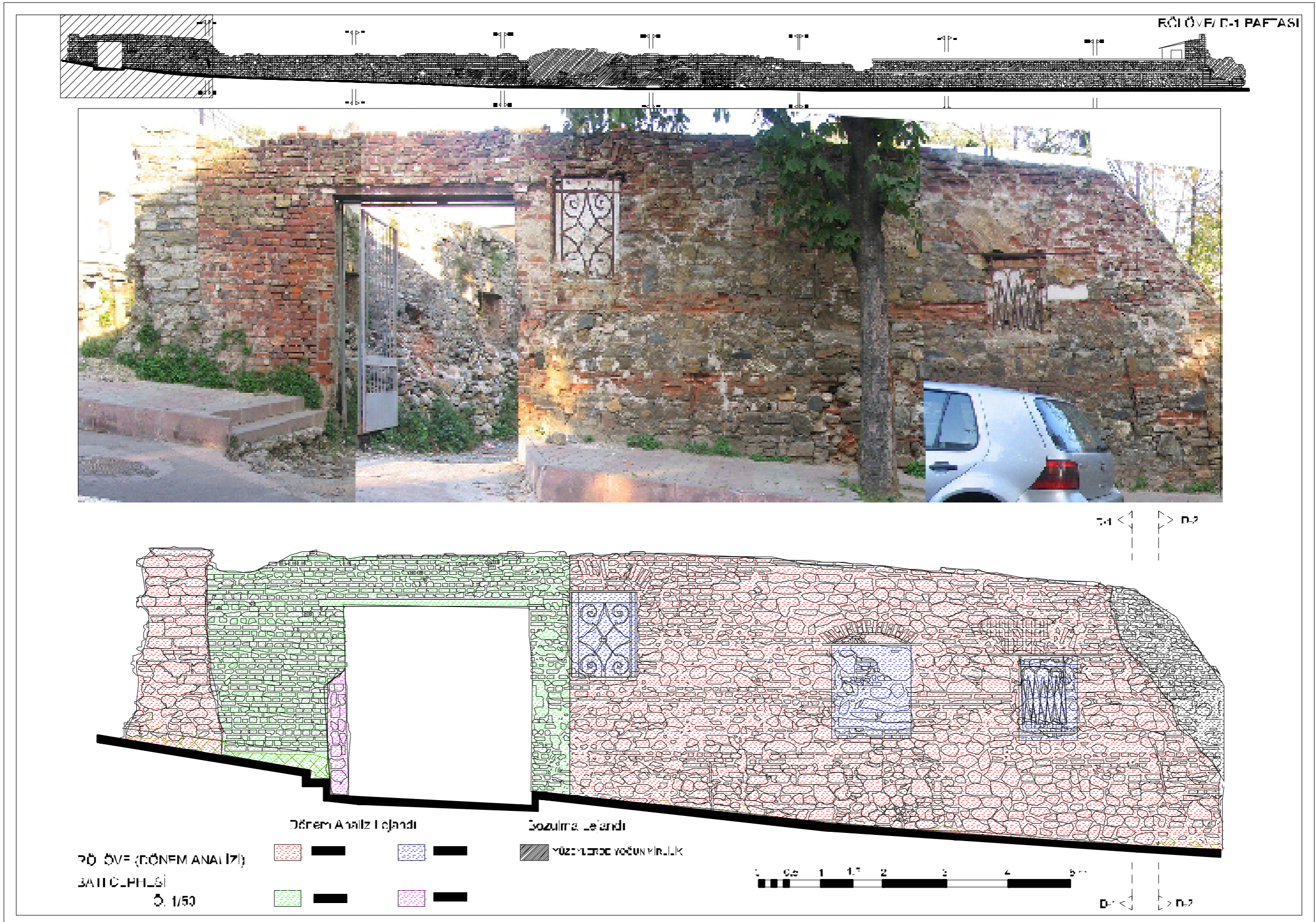
Şekil 4.35 Batı Duvarı, Dönem Analizi D-1 Paftası
