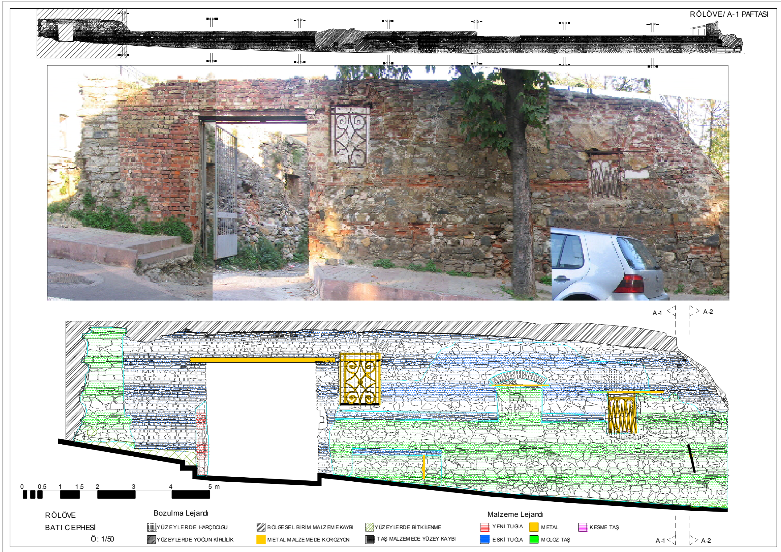
Şekil 4.26 Batı Duvarı, Batı Cephesi Rölöve A-1 Paftası
