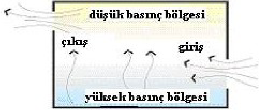
Şekil 4.24 Baca havalandırma (Stack ventilation) (CHPS, 2002)
