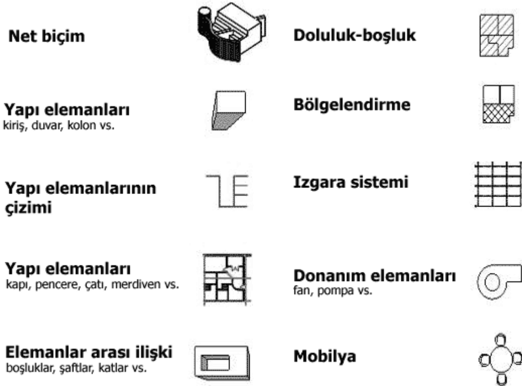
Şekil 3.3 IFC'nin geometrik tanımlama yetenekleri (Bazjanac, 2004).
