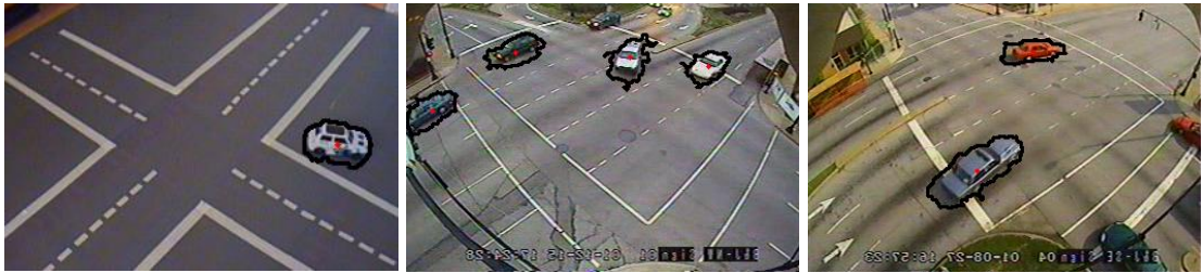
Şekil 4.5 Deney ve doğal sahneler üzerinde takip edilen araçların dış çevritlerinin belirlenmesi
