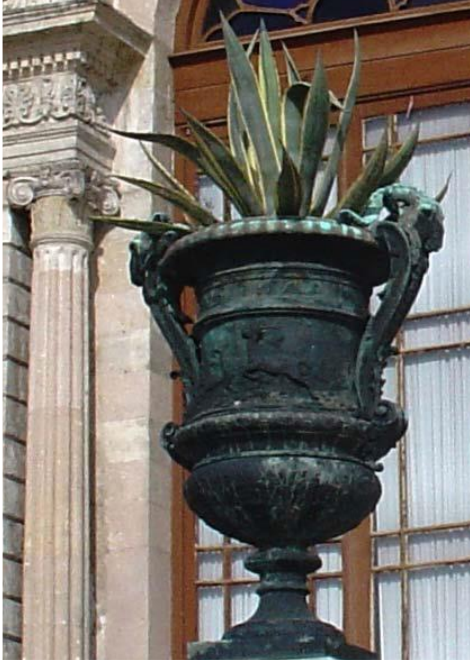
Şekil 3.50 Solda Dolmabahçe Sarayı'nda Mabeyn-i Hümayun'un önünde duran üzerinde bakır klorür birikimleri bulunan bronz vazo, sağda Beylerbeyi Sarayı bahçelerinden üzerinde bakır klorür birikimleri bulunan bronz heykel
