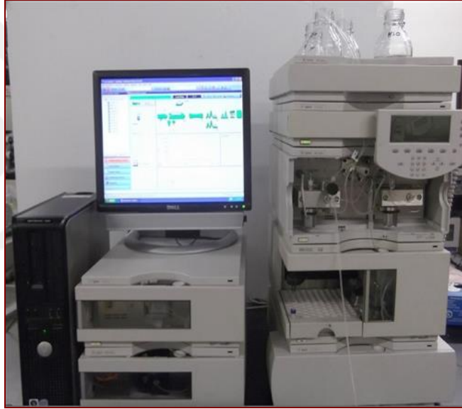
Şekil 3.12 Agilent 1100 serisi HPLC cihazı
