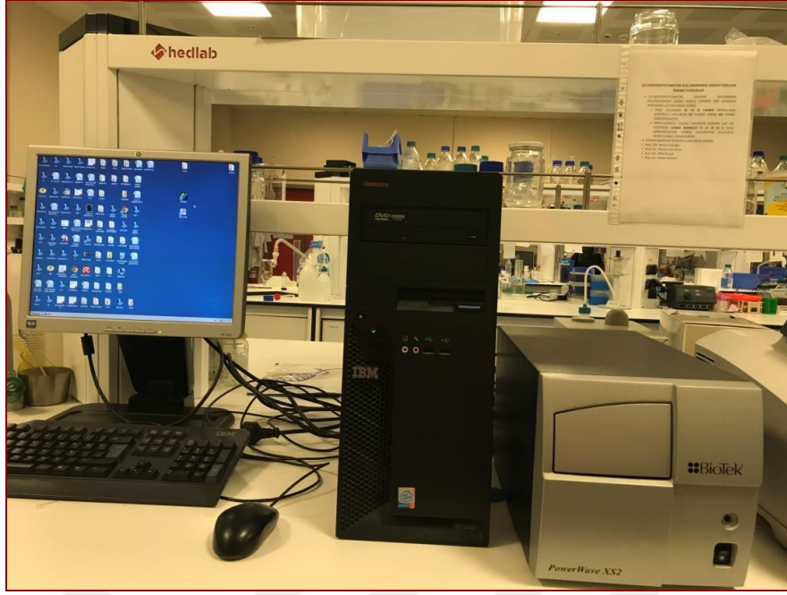
Şekil 3.11 Kullanılan ELISA cihazı (Power Wave XS2)
