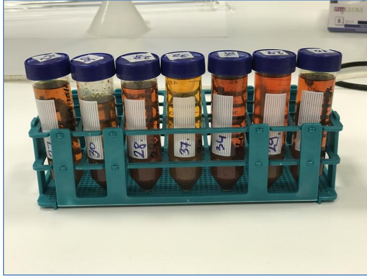
Şekil 3.3 Örneklerin 3.500 rpm de 5 dk santrifüj yapılmış şekli
