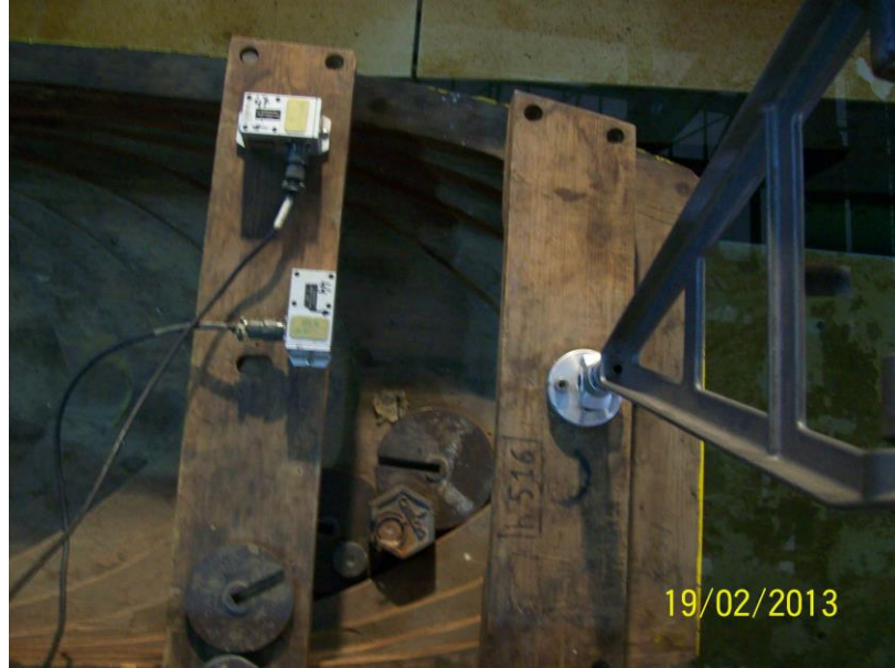
Şekil 4. 3 Paralel batma ve dinamik trim miktarını ölçen cihazlar
