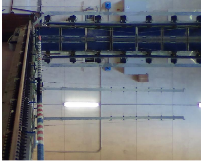
Şekil 4. 10 Serbest yüzey deformasyonu ölçümü için kullanılan sensörler
