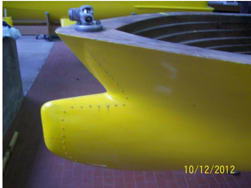
Şekil 4. 9 Model üzerine yerleştirilen türbülans yapıcı pinler
