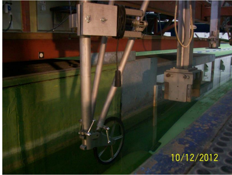
Şekil 4. 1 Direnç ölçümünde kullanılan ATWOOD sistemi
