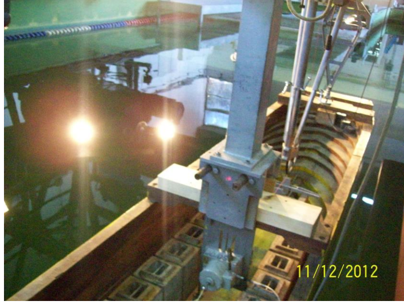
Şekil 4. 2 Direnç ölçümünde kullanılan R47 dinamometre
