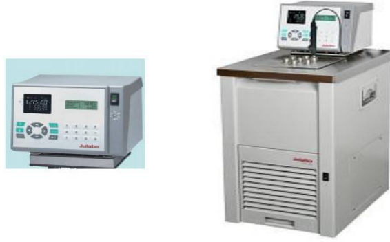
Şekil 4.39 Sıcaklık ölçüm cihazlarını kalibre etmek için kullanılan Julobo FK30- SL kalibrasyon banyosunun resmi
