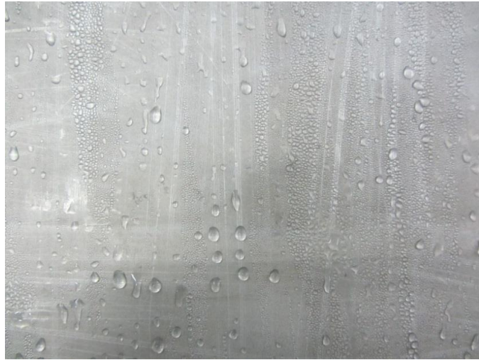
Şekil 4.11 Plaka üzerinde yoğuşma 480. dakika
