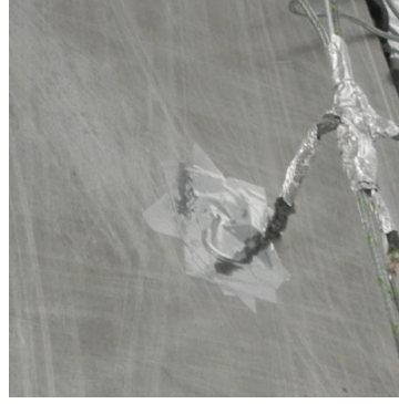
Şekil 3.30 Yoğuşturucu plaka yüzeyine konumlandırılan ısı çift ( T_{a0} )
