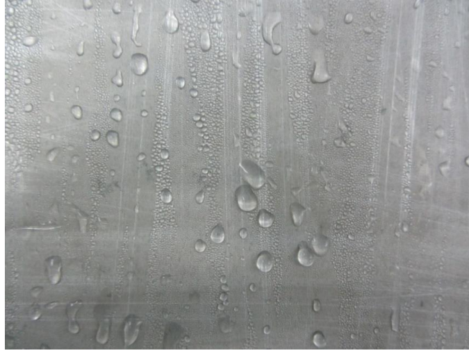
Şekil 4.10 Plaka üzerinde yoğuşma 300. dakika
