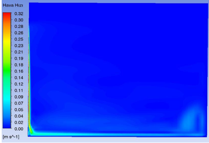
Şekil 2.28 Oda içerisindeki hava hız dağılımı
