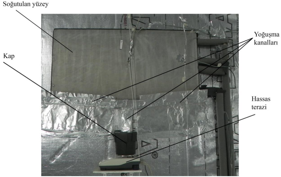
Şekil 3.16 Yoğuşturucu plakanın duvardaki konumu
