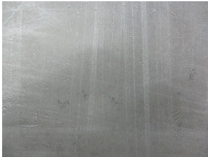
Şekil 4.2 Plaka üzerinde yoğuşma 60. dakika
