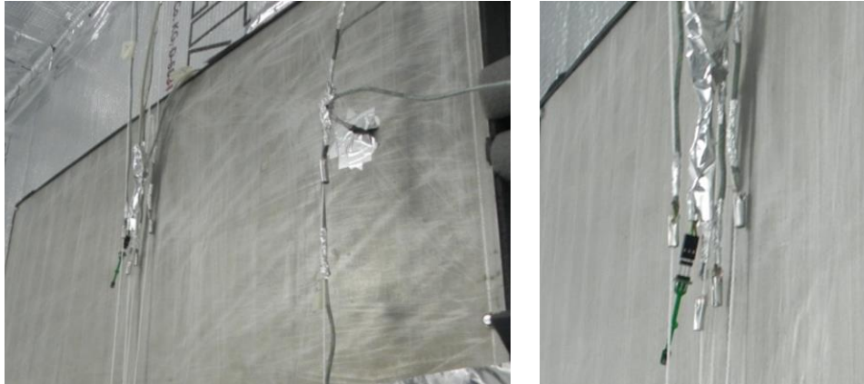
Şekil 3.29 Yoğuşturucu plaka yüzeyine yakın konumlandırılan ısı çiftleri ( T_{a1} - T_{a5} )
