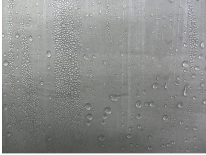
Şekil 4.8 Plaka üzerinde yoğuşma 210. dakika
