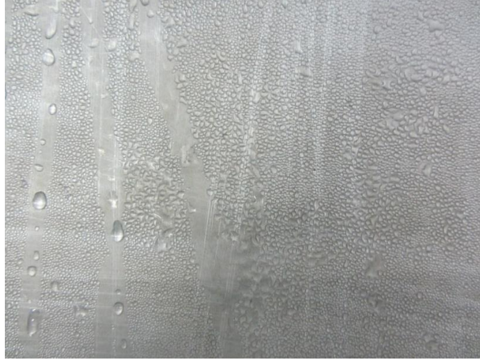
Şekil 4.5 Plaka üzerinde yoğunlaşma 120. dakika
