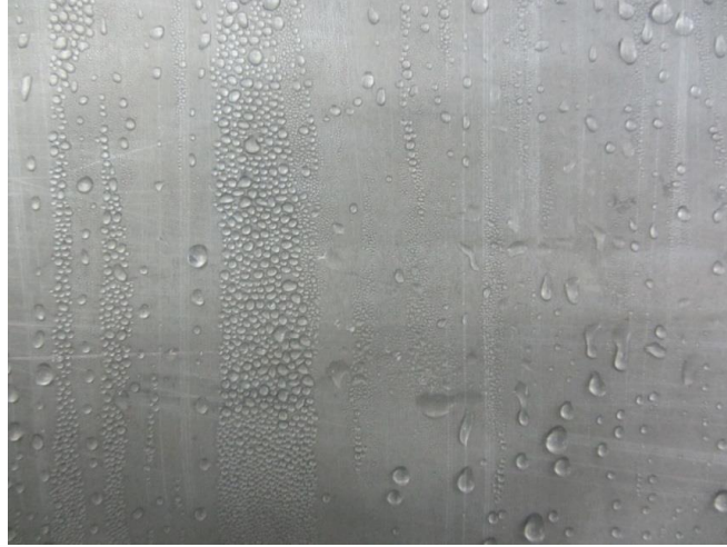
Şekil 4.9 Plaka üzerinde yoğuşma 240. dakika
