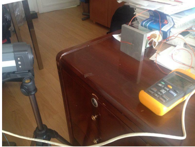
Şekil 3.45 Malzemelerin yayma oranı değerlerinin ölçümü
