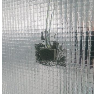
Şekil 3.31 Soğutulmayan duvarlara konumlandırılan ısı çift ( T_{s1} - T_{s6} )
