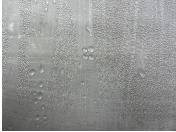
Şekil 4.6 Plaka üzerinde yoğuşma 150. dakika
