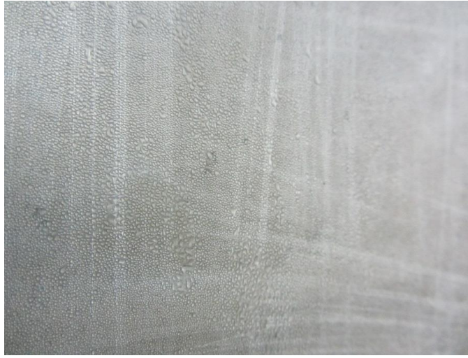
Şekil 4.3 Plaka üzerinde yoğuşma 75. dakika
