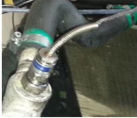
Şekil 3. 19 Soğutma suyu termokupl bağlantıları
