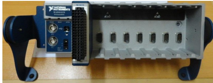
Şekil 3. 22 National Instruments cDAQ modül şasisi
