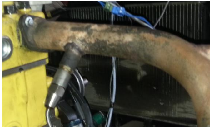
Şekil 3. 20Egzoz hattı termokupl bağlantısı
