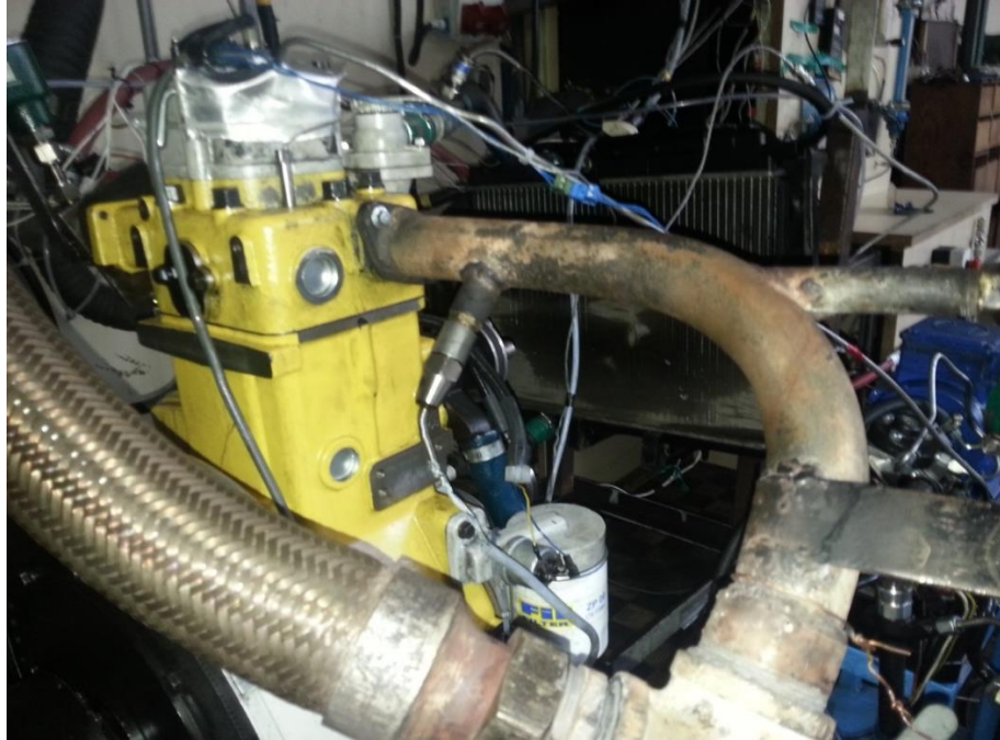
Şekil 3. 10 Motorun egzoz manifoldunun fotoğrafı
