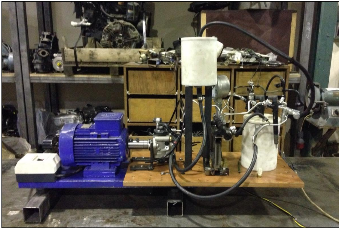
Şekil 3. 7 Dizel yakıt sistemi similatörü şematığı ve fotoğrafı
