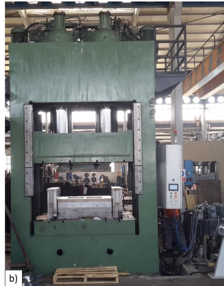
Şekil 5. 5 a) Elektrik motorları, pompalar ve oransal valflerin monte edildiği depo, b) Deponun kalıpla bağlantısının sağlanmış hali
