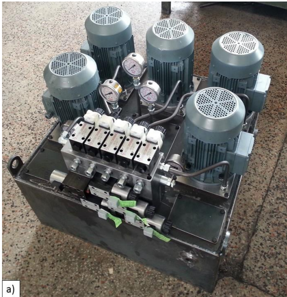
Şekil 5. 5 a) Elektrik motorları, pompalar ve oransal valflerin monte edildiği depo, b) Deponun kalıpla bağlantısının sağlanmış hali
