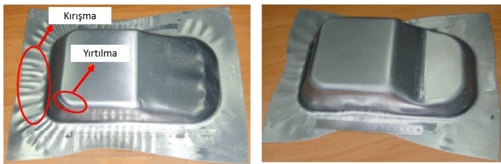
(a) Sabit pot çemberi basıncı (H = 45mm)
