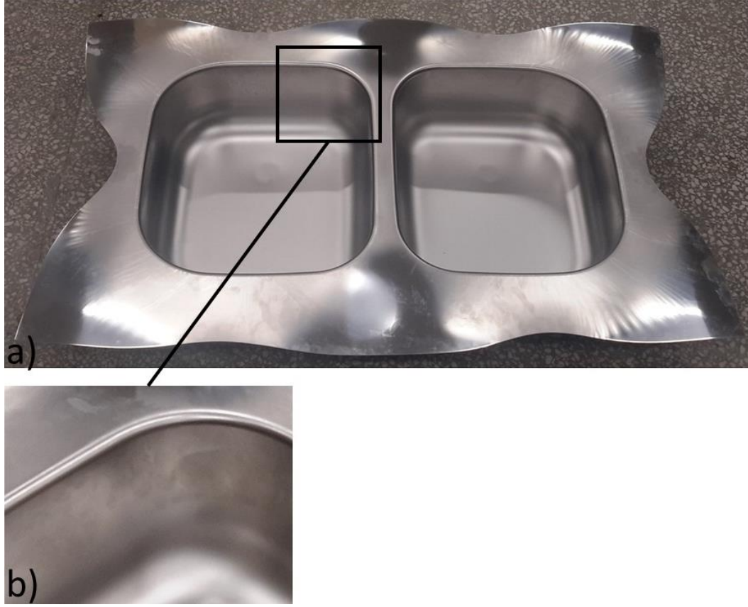
Şekil 6. 9 a) Köprü bölgesini kontrol eden 2 nolu pistonun basıncında yapılan değişikliğe göre gerçekleştirilen deney sonrası elde edilen parça, b) Yan duvar
