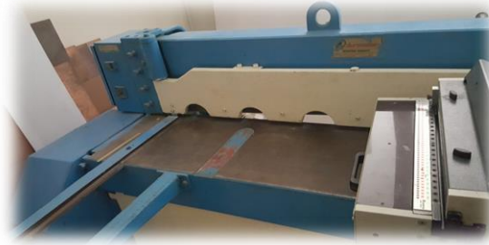
Şekil 3. 10 Bilgisayar kontrollü giyotin yardımıyla numunelerin kesilmesi
