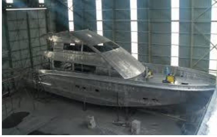
Şekil 2. 5 Tamamen alüminyumdan yapılmış bir tekne[55]
