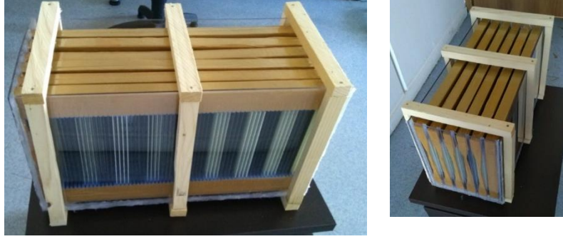
Şekil 3. 19 Akvaryumun etrafına çerçevenin monte edilmesi
