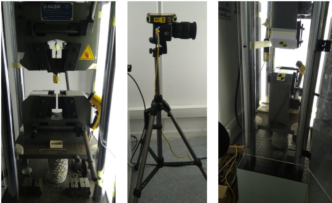
řekil 3. 46 ekme Cihazı, IR Termometre, Mikrofon ve Yksek Hızlı Kamera
