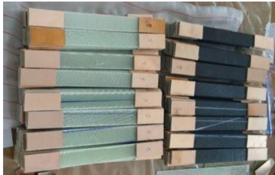
Şekil 3. 44 Tab malzemelerin yapıştırıldığı numunelerin görünümü
