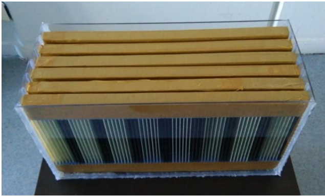
Şekil 3. 18 Altı peteğin akvaryuma yerleştirilmesi.
