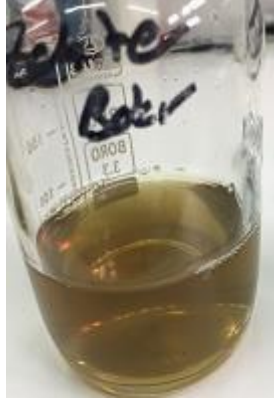
Şekil 4.53 T. spicata yaprak ekstraktı \text{CuSO}_4 \cdot 5\text{H}_2\text{O} karışımı sonrası CuONP sentezini gösteren renk değişimi
