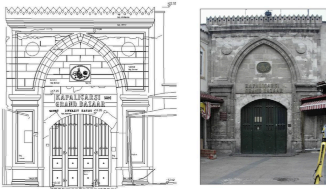
Şekil 5.52 Beyazıt Kapısı ve rölövesi 96
