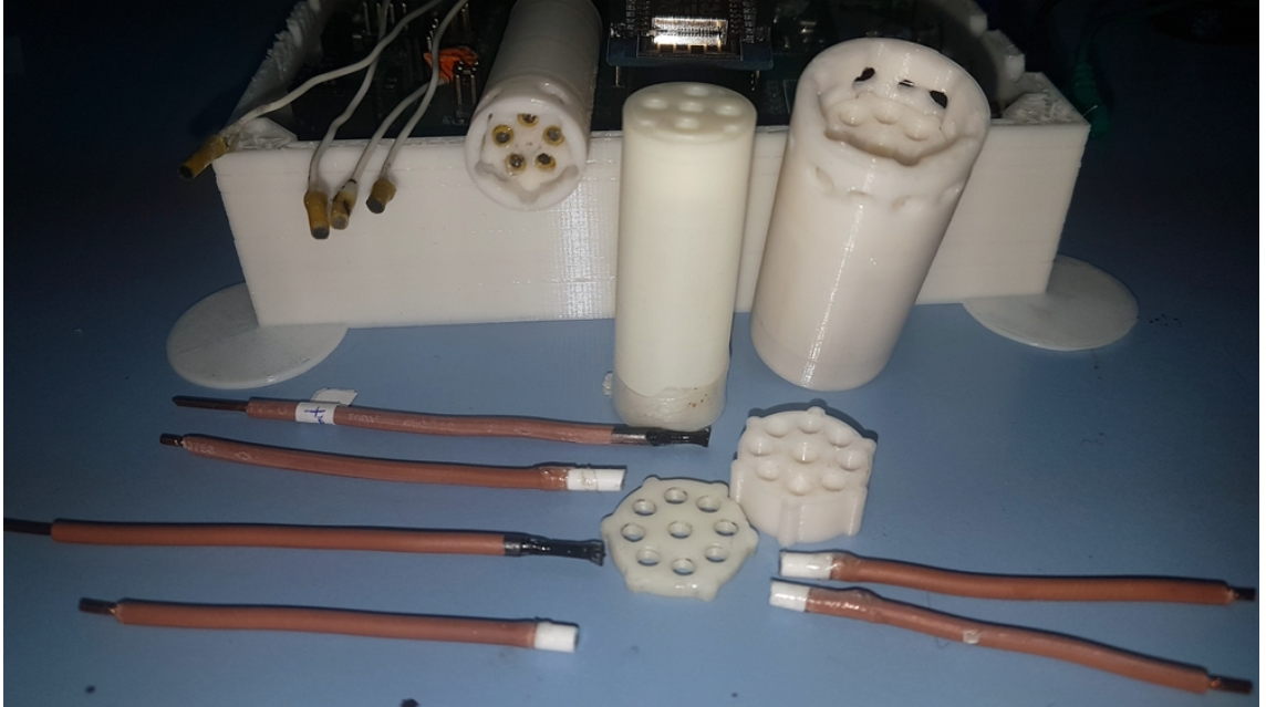
Şekil 3.24 Başka bir 3B baskı kutu içerisinde kartlar, çoklu sensör tutucuları ve çeşitli sensörler
