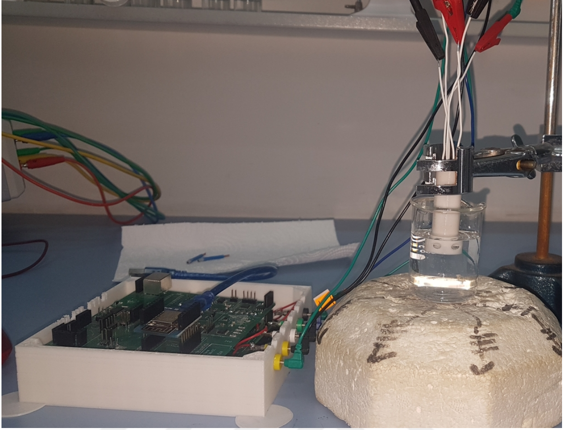
Şekil 3.23 Beşli sensör tutucu ve sistemin ölçme sırasındaki görüntüsü
