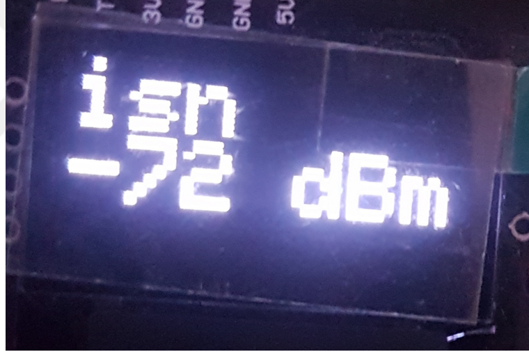
Şekil 4.3 OLED ekranda RSSI sonuçları
