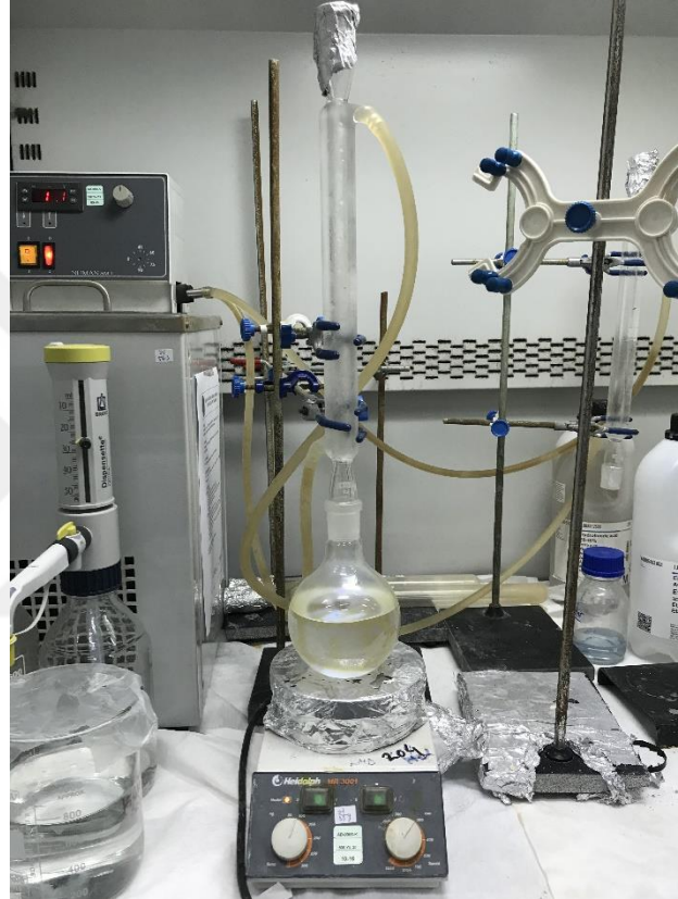
Şekil 5.3 Mg silika aerjellerin APTES ile modifikasyonu
