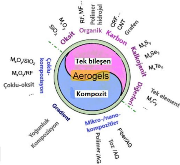
Şekil 2.2 Aerojellerin kompozisyonlarına göre sınıflandırılması [28]
