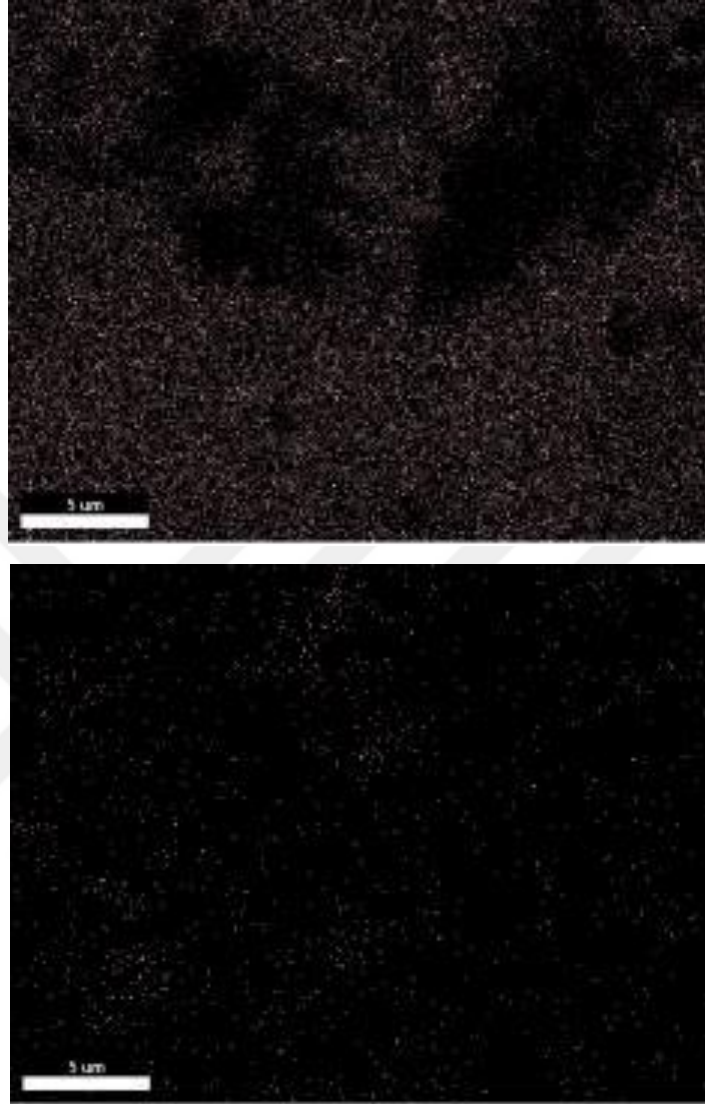
Şekil 4.12 Üstte yeni bir mRE2 elektrot yüzeyi, altta ise liç testi sonrası mRE2 elektrot yüzeyi potasyum haritalama sonuçları
