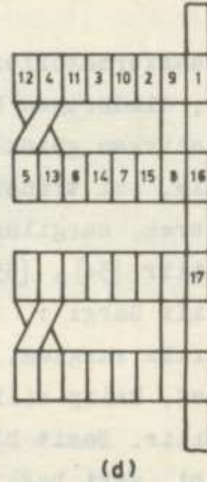
Şekil-9 Güç transformatörlerinde kullanılan sargı türleri.
