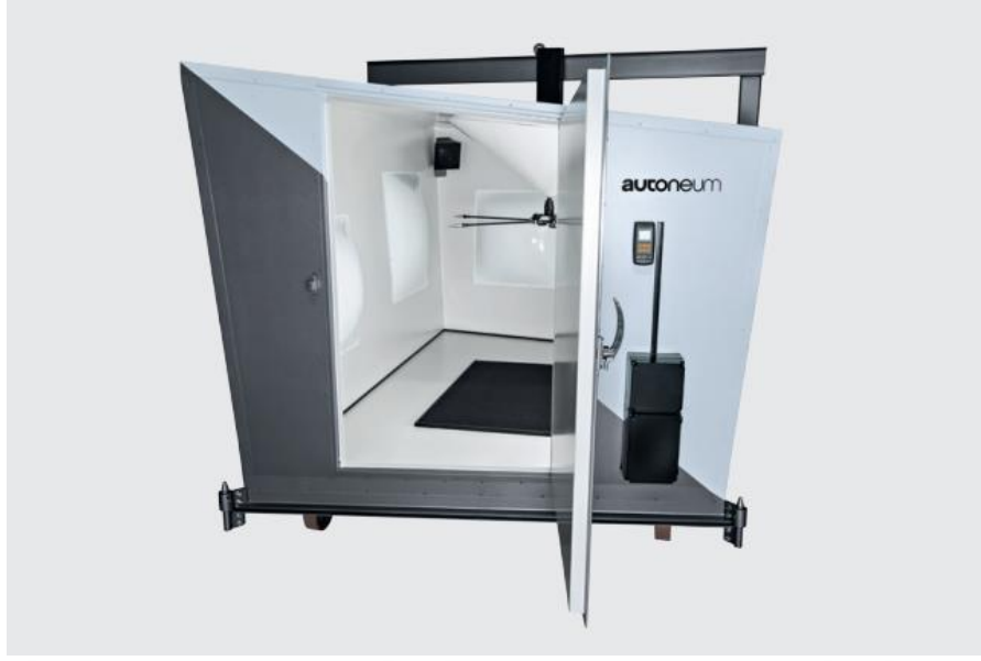
Şekil 2.6 Autoneum Mini Yansıyım Kabini (Alpha Cabin) [79]
