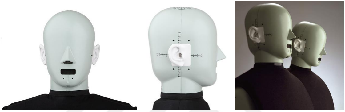
Şekil 4.46 Baş ve Göğüs Simülatörü (Head & Torso Simulator) [139]
