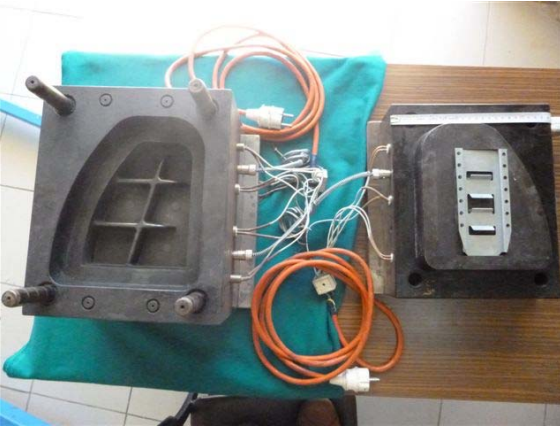
Şekil 3. 22 Gerçek boyuttaki balata basılmasında kullanılan kalıp
