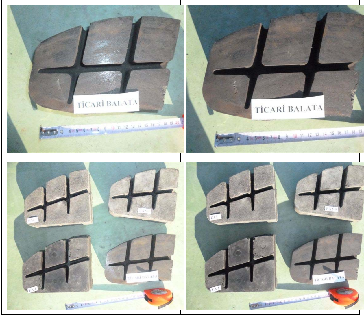
Şekil 3. 27 Laboratuarda üretilen EA1, EA2 ve EA2-P prototipler disk balatalar
