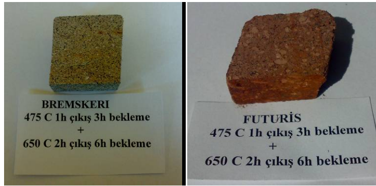
Şekil 3. 13 Bremskerl® ve Futuris® marka balataların termoliz sonrası fotoğrafları
