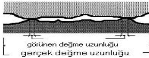
Şekil 2. 4 Metal üzeri metal değme alanı [29]
