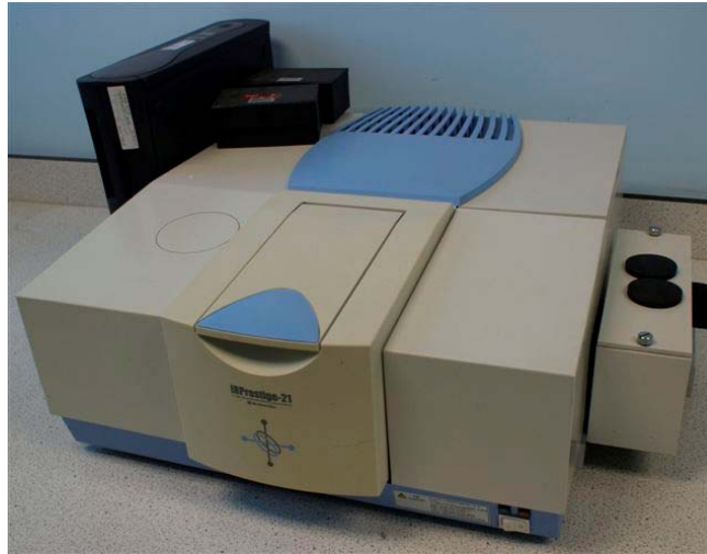
Şekil 3. 4 Shimadzu IR Prestige21 FTIR cihazı
