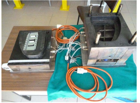
Şekil 3. 22 Gerçek boyuttaki balata basılmasında kullanılan kalıp
