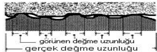
Şekil 2. 5 Metal üzeri kauçuk değme alanı [29]
