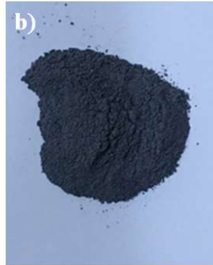
Şekil 7.21 Ağırlıkça %10 oranında B içeren B-TiO 2 nano parçacıkların (a) 10M NaOH çözeltisi ile karıştırılma sonrası ve (b) 135°C'de 24 saat süreyle tabii tutulduğu hidrotermal işlem sonrası elde edilen nanotüplerin görüntüsü
