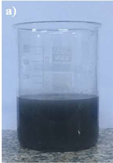
Şekil 7.21 Ağırlıkça %10 oranında B içeren B-TiO 2 nano parçacıkların (a) 10M NaOH çözeltisi ile karıştırılma sonrası ve (b) 135°C'de 24 saat süreyle tabii tutulduğu hidrotermal işlem sonrası elde edilen nanotüplerin görüntüsü
