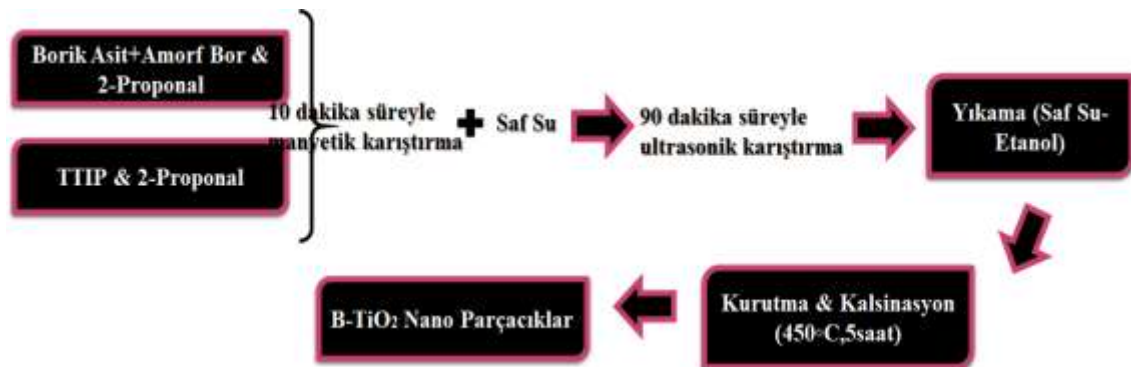
Şekil 7.4 B-TiO 2 nano parçacıkların sentezlenmesine ait akım şeması
