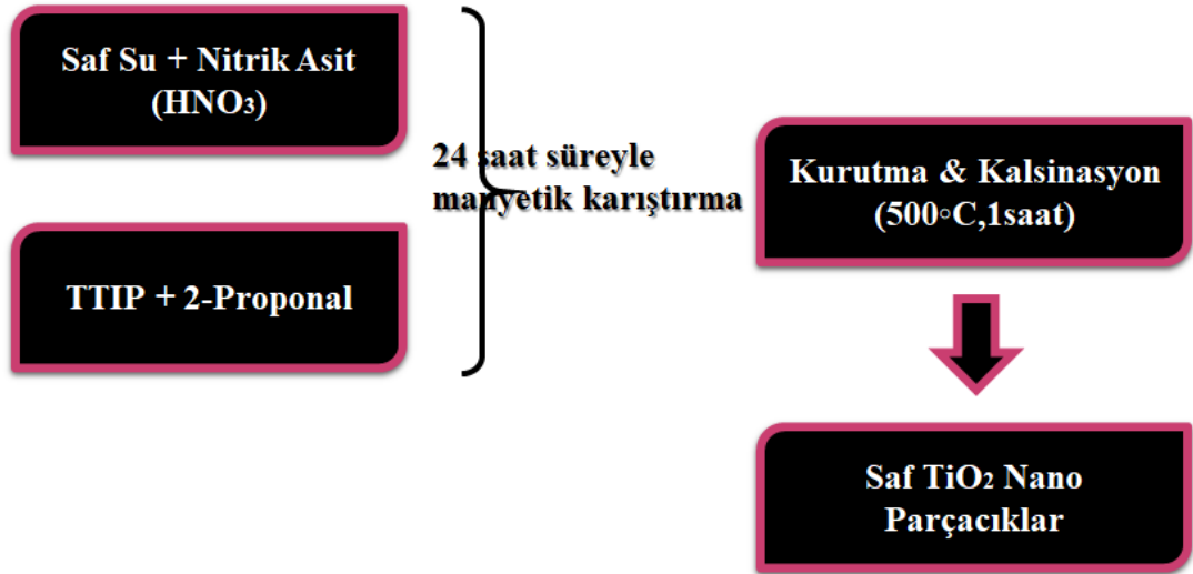
Şekil 7.2 Saf TiO 2 nano parçacıklarının sentezlenmesine ait akım şeması
