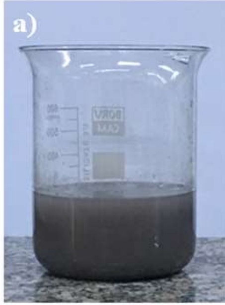
Şekil 7.20 Ağırlıkça %5 oranında B içeren B-TiO 2 nano parçacıkların (a) 10M NaOH çözeltisi ile karıştırılma sonrası ve (b) 135°C'de 24 saat süreyle tabii tutulduğu hidrotermal işlem sonrası elde edilen nanotüplerin görüntüsü.
