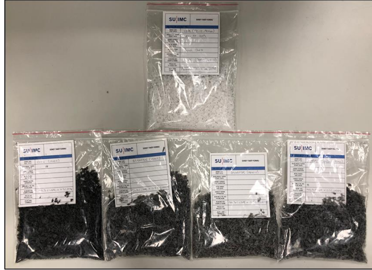
Şekil 2.13 LDPE-saf ve LDPE-B 4 C kompozit granüller
