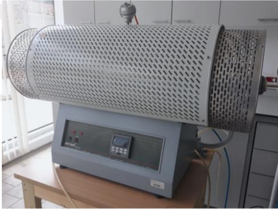
Şekil 2.9 Çalışmada kullanılan tüp fırın
