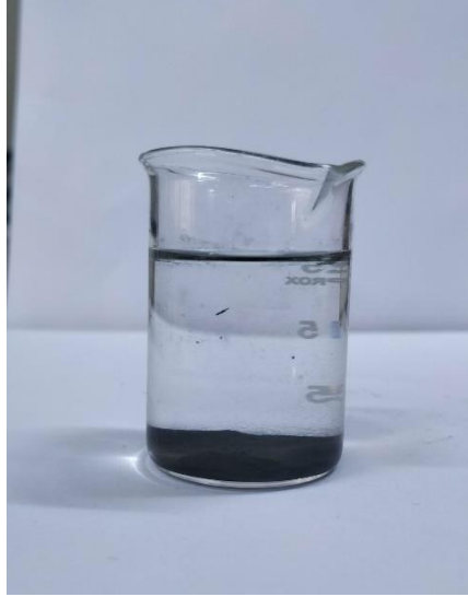
Şekil 3.104 Mikrodalgada işlem görmüş ve asit çözeltisinde çökmüş bor karbür tozları
