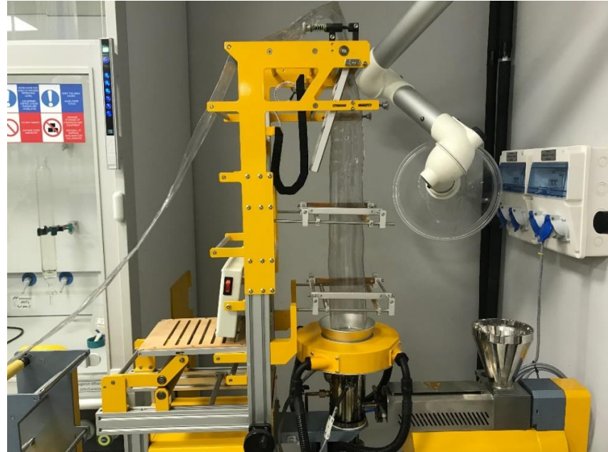
Şekil 2.17 B 4 C takviyeli polimer kompozitlerin üflemleri mini film cihazı kullanılarak üretimi.
