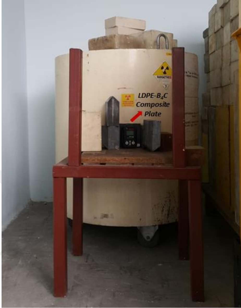
Şekil 2.18 Nötron kalkanlama performansı ölçüm düzeneği
