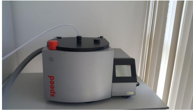
Şekil 3.102 Bor karbürün çözülmesinde kullanılan 2000 W gücünde ve maksimum çalışma sıcaklığı 250°C olan mikrodalga ünitesi
