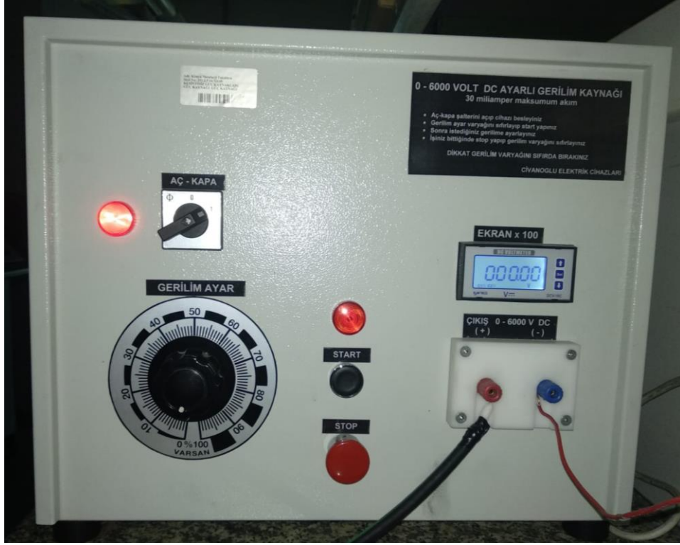
Şekil 3.10 Deneysel çalışmanın başlarında kullanılan 6kV çıkışa sahip DC güç kaynağı
