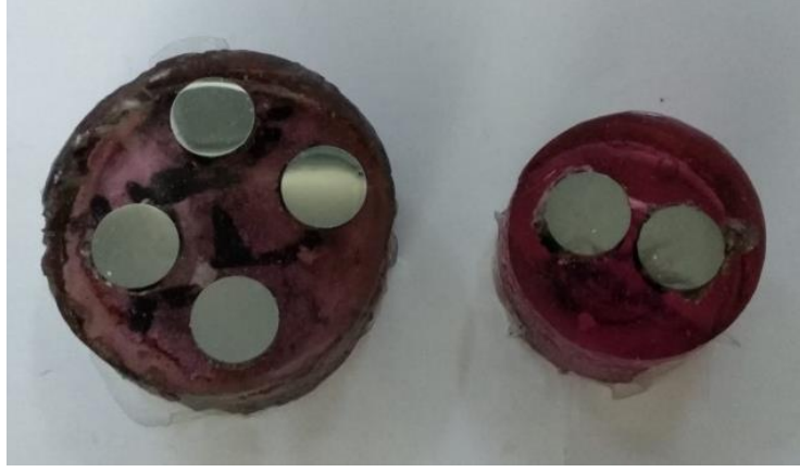
Şekil 3.28 Metalografik işlemler için montelenmiş numuneler
