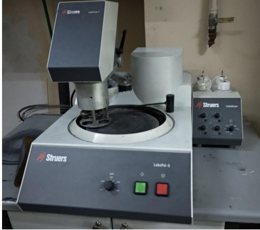
Şekil 3.30 Zımparalama ve parlatma işlemlerinde kullanılan otomatik yüzey hazırlama cihazı
