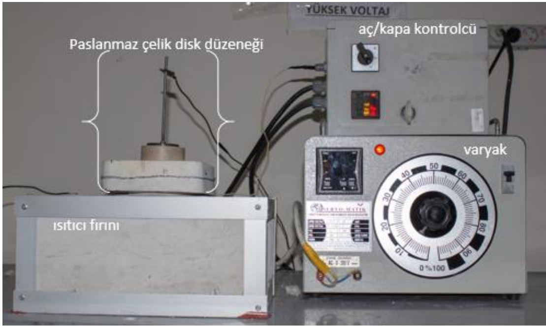
Şekil 3.6 Isıtıcı fırın ve kontrol düzeneği
