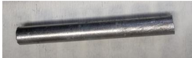
Şekil 3.26 Katılaştırma deneyleri sonucu elde edilen bir numune örneği
