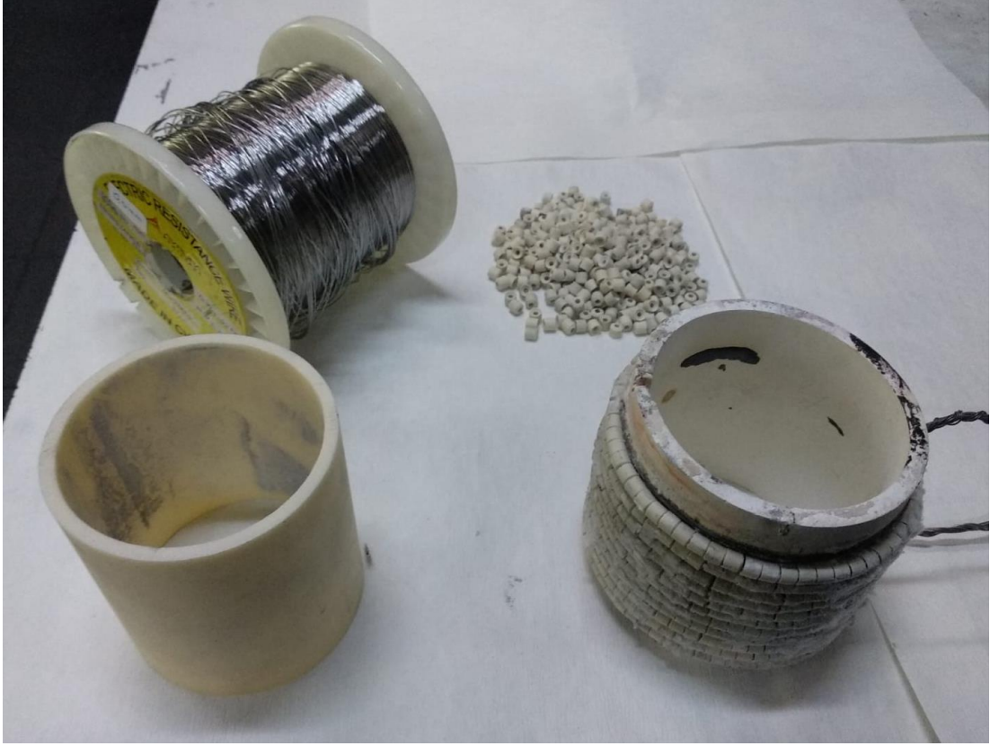
Şekil 3.2 Direnç telleri, seramik boncuklar ve alümina tüp kullanılarak hazırlanan ısıtıcı bölge
