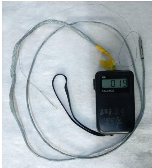
Şekil 3.5 Fırın stabilizasyonunda kullanılan seyyar sıcaklık okuyucu
