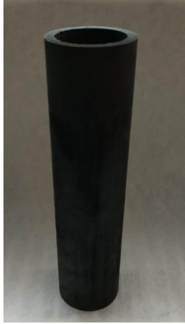
Şekil 3.20 Sıvı alaşımların hazırlanmasında kullanılan grafit pota
