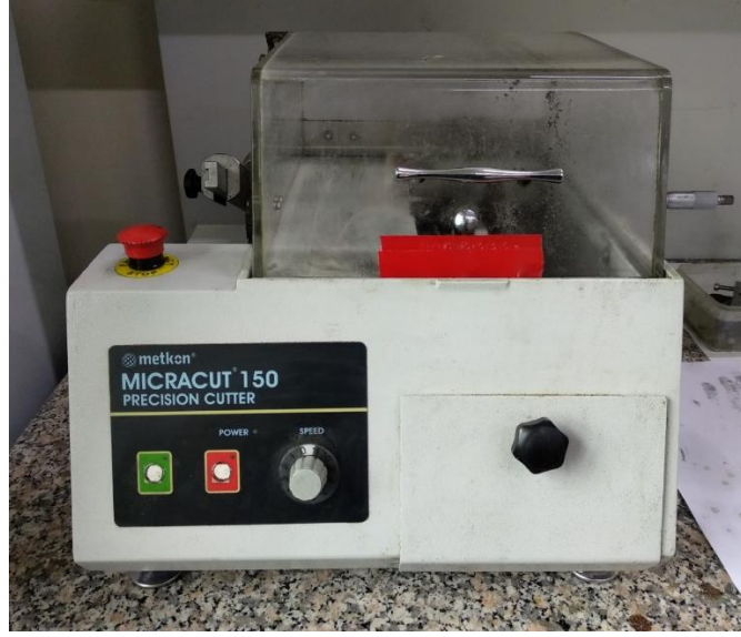
Şekil 3.27 Deneysel çalışmalarda kullanılan hassas kesici
