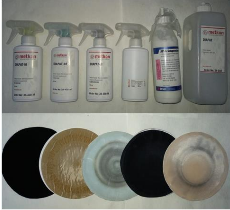
Şekil 3.31 Parlatma işlemlerinde kullanılan süspansiyonlar ve özel çuhaları
