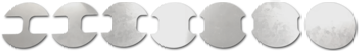
Şekil 7.5 Nakajima testi numune görselleri [127]
