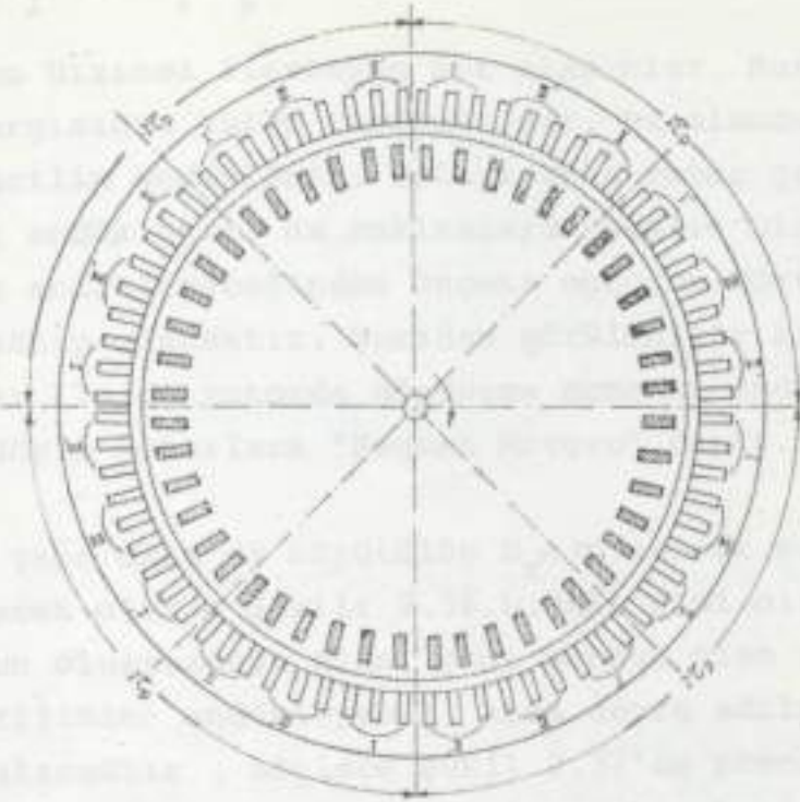
Şekil: 2.35. 8 kutuplu üç fazlı kısa devre rotorlu normal bir asenkron motor kesiti (12)
