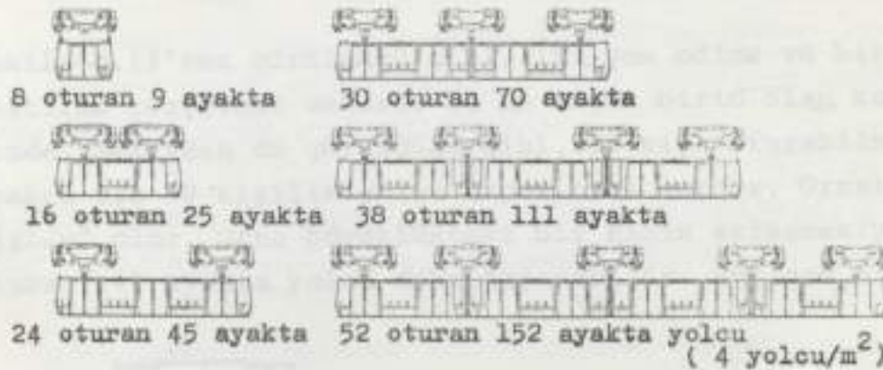
Şekil: 2.12. Çeşitli boyutlardaki UYET kabinleri
