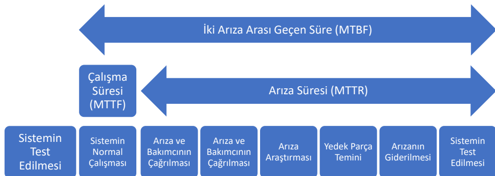
Şekil 2.6 Sistem çalışma ve arıza döngüsü
