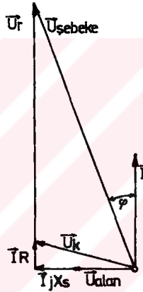
Şekil: 3.2. - Bir fazlı kollektörlü seri motorun fazör diyagramı
