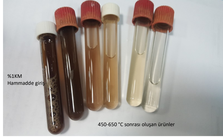
Şekil 5.10 Arıtma çamurunun farklı sıcaklıklarda süperkritik gazifikasyonu sonucu oluşan sıvı ürünlerin görüntüleri (%1 KM, 25 MPa, 450-650°C)
