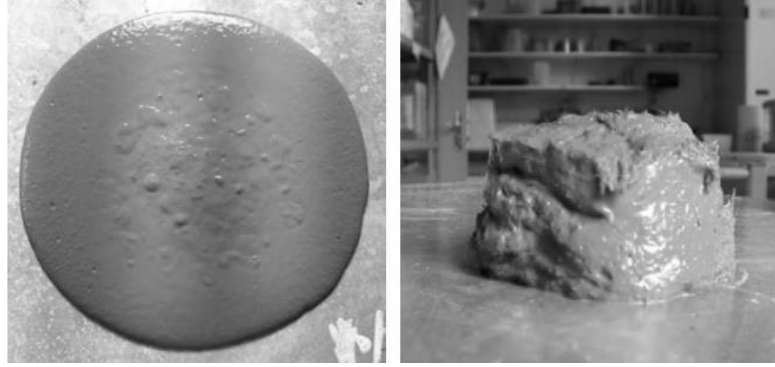
řekil 2.5 Farklı narinlik oranına sahip elik liflerle ۆretilen UHPC malzemesi [45]
