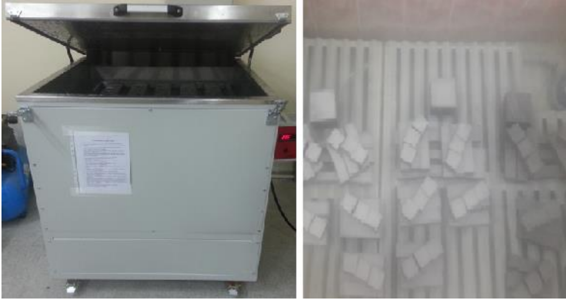
Şekil 3.7 Buhar kürünün uygulandığı buhar tankı (solda) ve su kürünün uygulandığı havuzlar (sağda)
