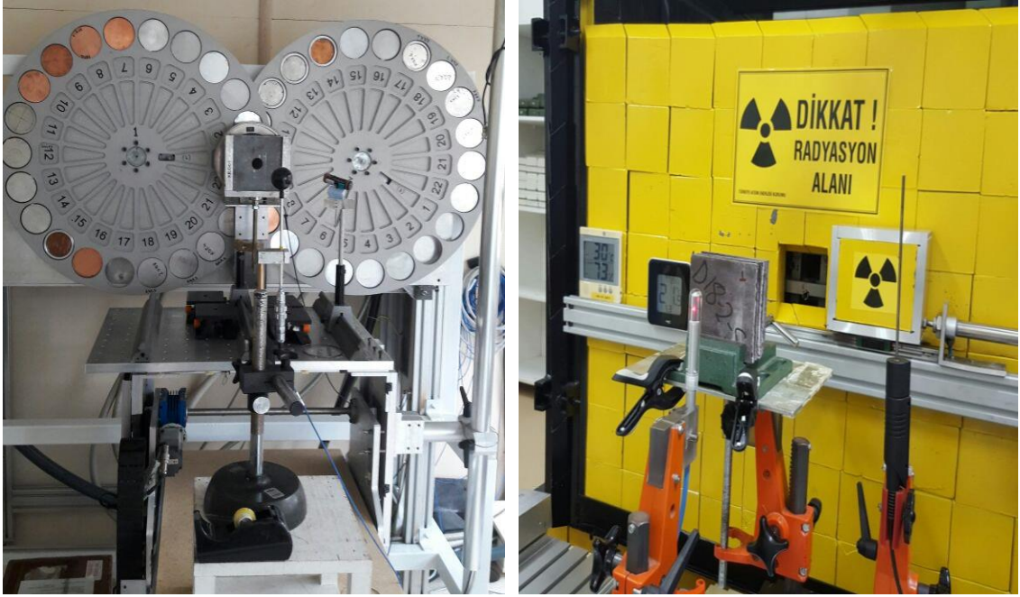
Şekil 3.17 Radyasyon geçirgenlik ölçümü deney düzeneği: X-ışını dozimetre cihazı (solda) ve gama ışını ölçüm cihazı (sağda)
