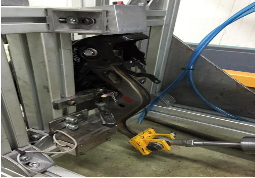
Şekil 5.2 Test Düzeneğinde Pedalın Konumu
