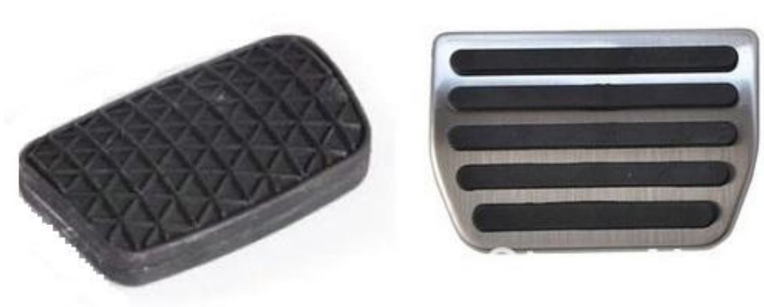
Şekil 2. 3 Kauçuk ve Metal Fren Pedalı Basma Yüzeyleri
