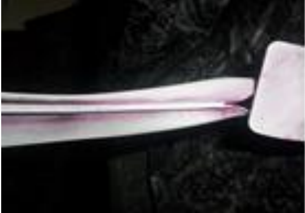
Şekil 5. 9 500.000 Çevrim Sonundaki Yorulma Testi Sonucu (1.2-1.2 mm)
