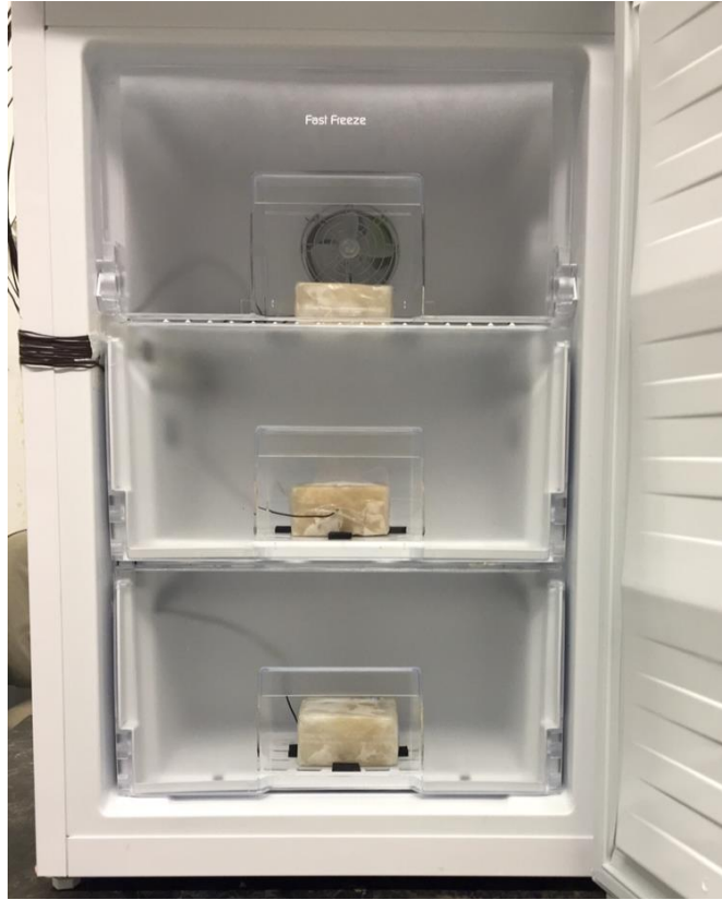
Şekil 3. 4 M-paketlerin dolap içindeki yerleşimi
