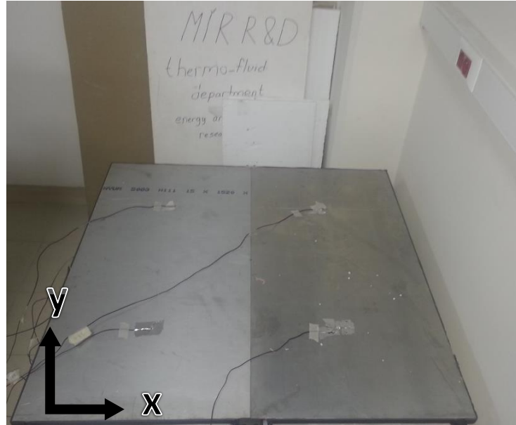
Şekil 4.13 Soğutma plakası ve üzerine yerleştirilen ısı çiftler
