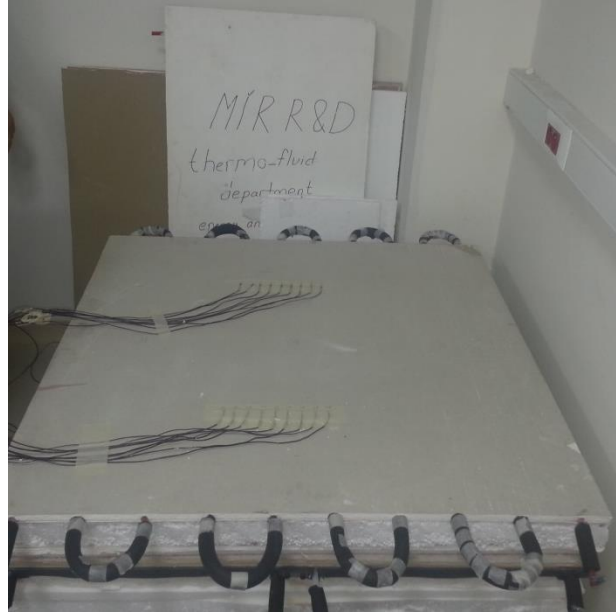
Şekil 4.14 Soğutma plakası üzerine yerleştirilen hibrid duvar numunesi
