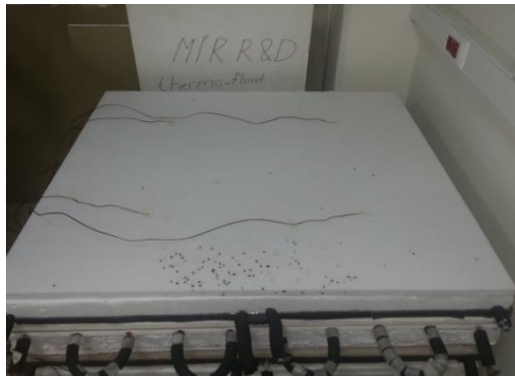
Şekil 4.23 Deney düzeneğinde hava sıcaklığını ölçmek için yerleştirilen ısı çiftler
