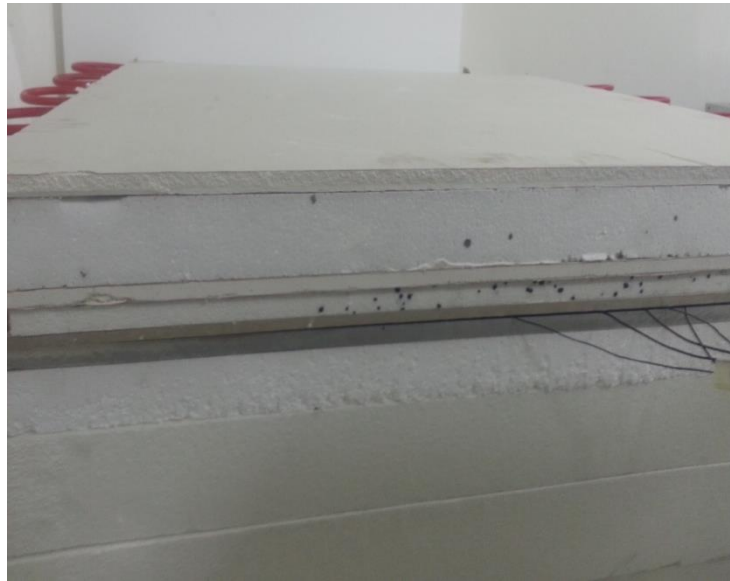
Şekil 4.15 Hibrid duvar numunesinin kesit görüntüsü
