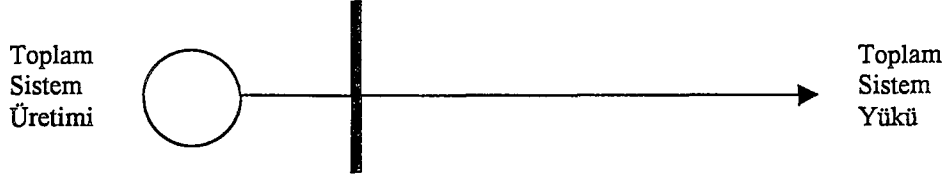
Şekil 4.2. Üretim kapasitesi, güvenilirlik değerlendirmesi için eşdeğer sistem modeli
