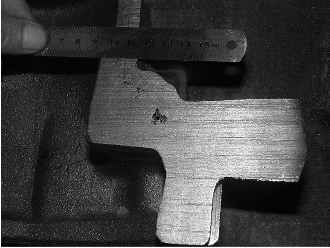
Şekil 6.45 Parçanın kesit görüntüsü ve çekinti
