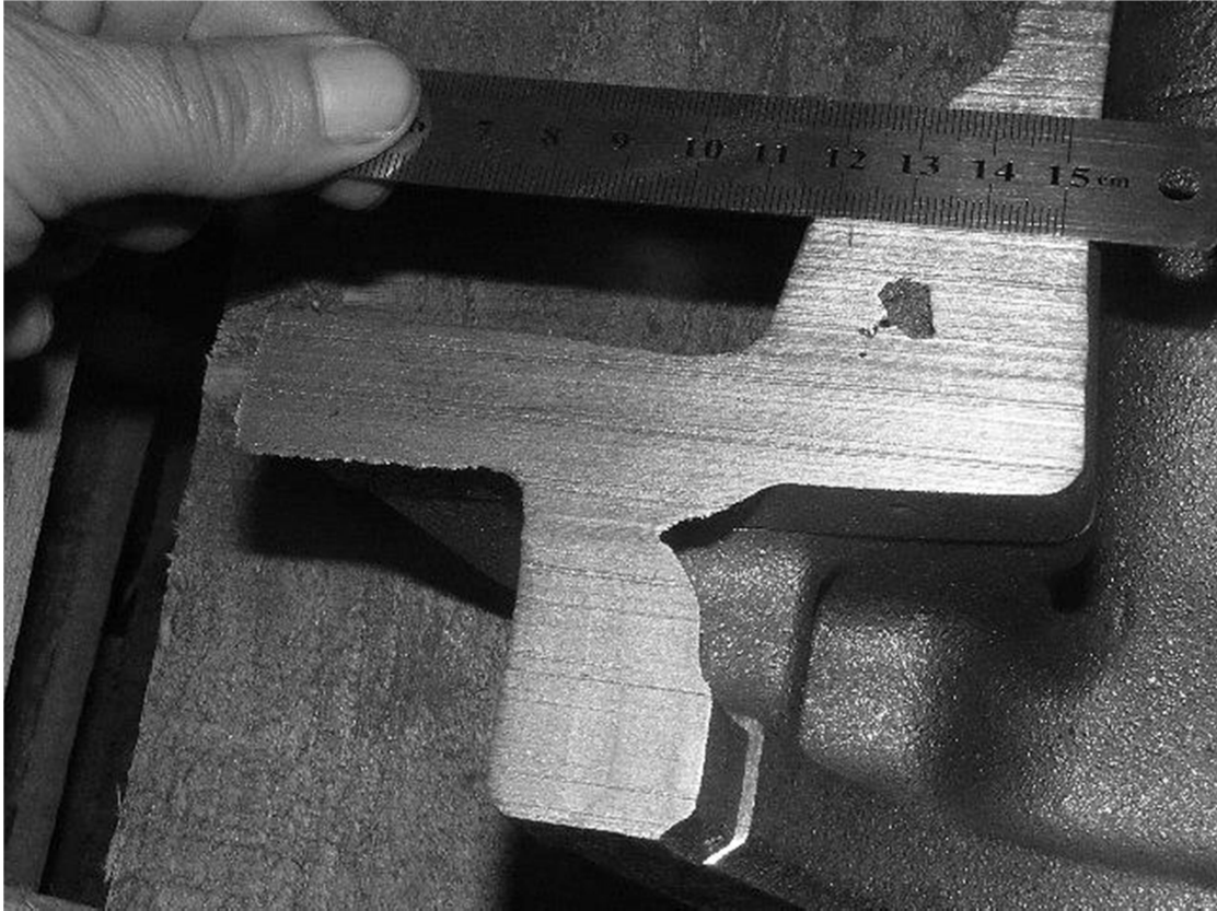
Şekil 6.46 Parçanın kesit görüntüsü ve çekinti
