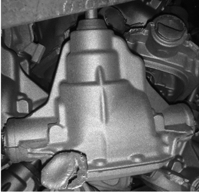
Şekil 6.59 Yeni yolluk ile dökülen parçalarda katmer sakatı gözlemi
