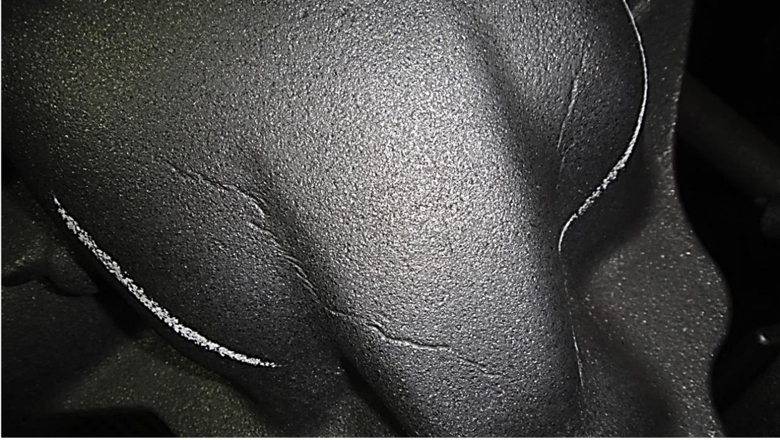
Şekil 6.33 Proje parçasında gözlemlenen katmer sakatı
