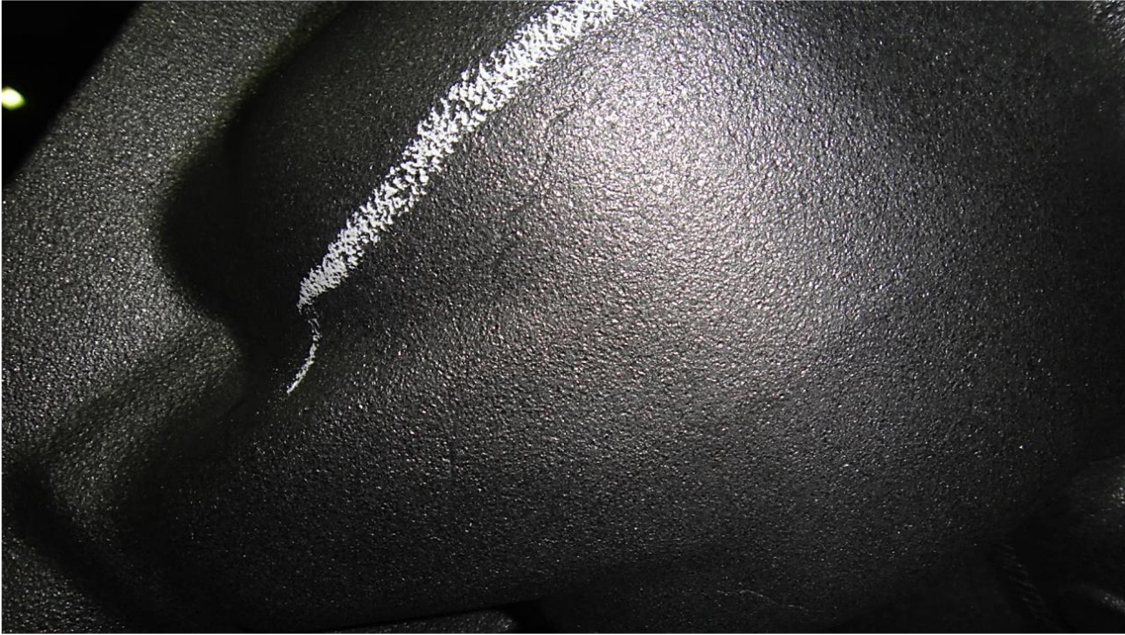
Şekil 6.34 Proje parçasında gözlemlenen katmer sakatı
