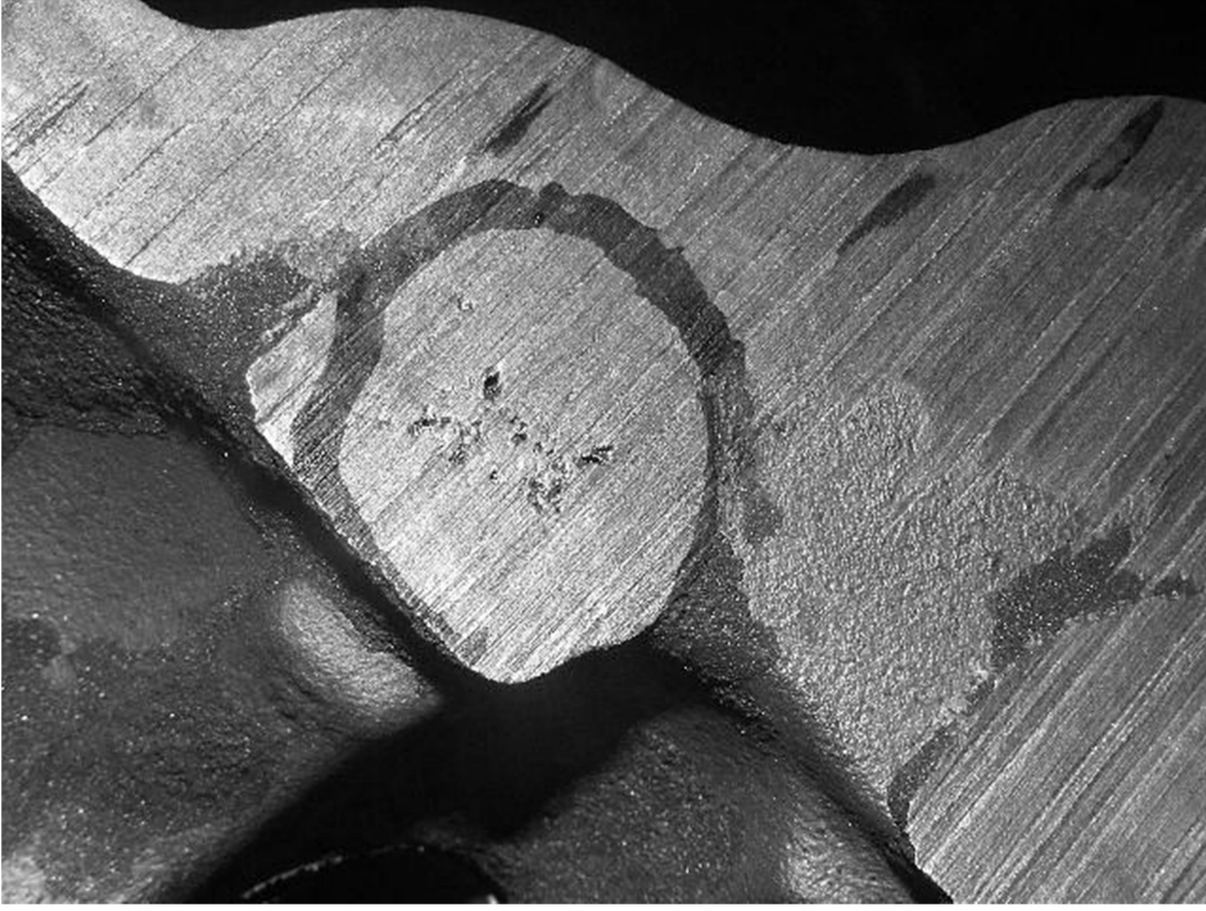
Şekil 6.47 Parçanın kesit görüntüsü ve çekinti
