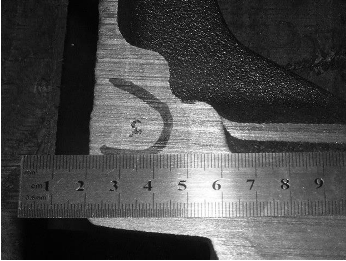
Şekil 6.49 Parçanın kesit görüntüsü ve çekinti
