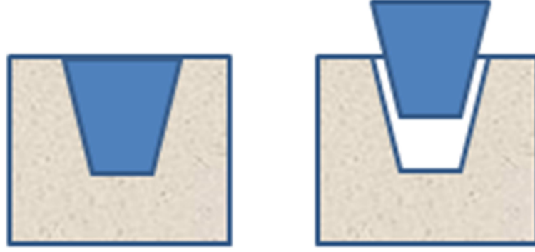
Şekil 2.4 Doğru dizayn edilmiş model ile yapılan kalıplama
