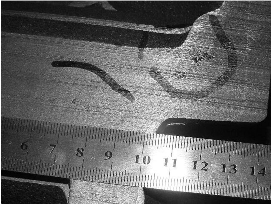
Şekil 6.50 Parçanın kesit görüntüsü ve çekinti
