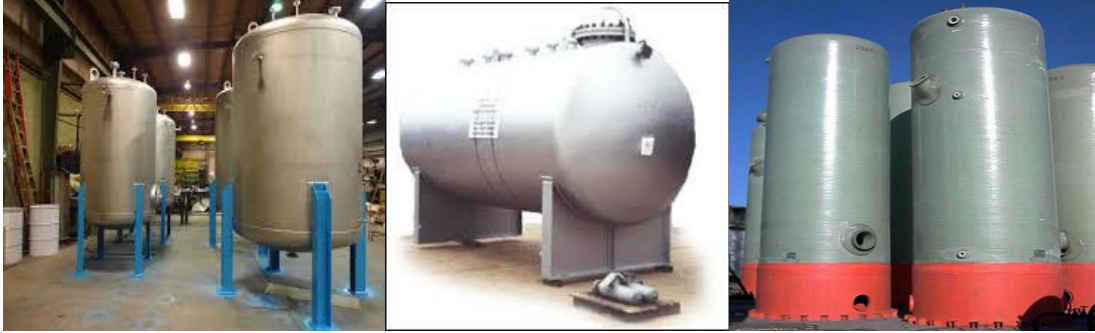
Şekil 2. 13 Ayak, eyer ve etek destek elemanları
