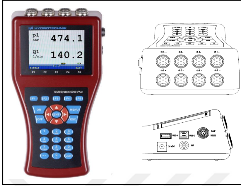
Şekil 3. 7 Veri toplama cihazı, ölçüm kanalları, veri giriş-çıkış portları [20]
