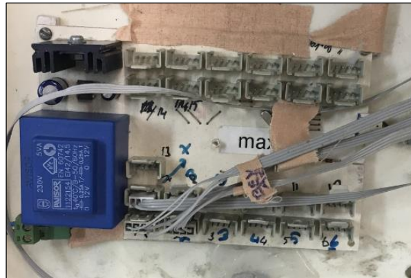
Şekil 6.9 Nem sensörleri için kullanılan elektronik kart
