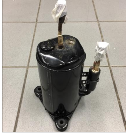
Şekil 6.5 Kompresör ve akü (kompresörün sağ tarafında)
