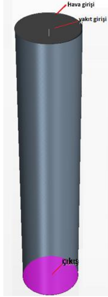
Şekil 3.3 Star-CCM+' da çizilen kireç şaft fırını geometrisi
