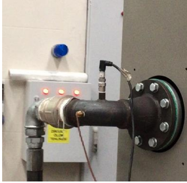
Şekil 5.6 Kompresör çıkışındaki sıcaklık ve basınç ölçümü
