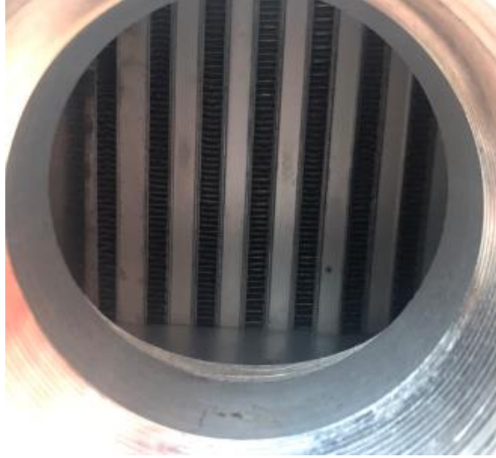
Şekil 2.12 Basınçlı havanın geçtiği radyatör yüzeyindeki finlerin dizilimi
