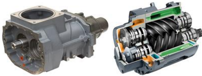
Şekil 2.2 Yağ enjeksiyonlu ve yağsız vida ünitesinin gerçek görüntüleri
