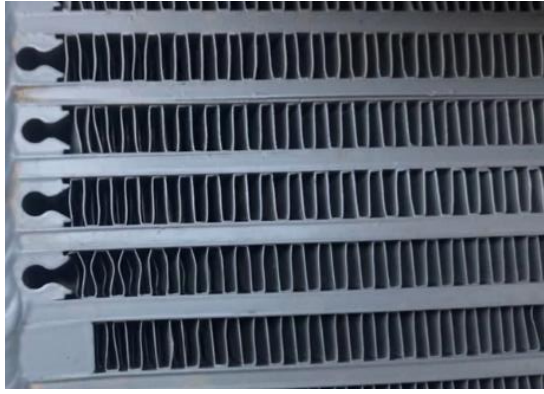
Şekil 2.11 Soğutma havasının geçtiği radyatör yüzeyinin geometrik şekli ve finlerin dizilimi
