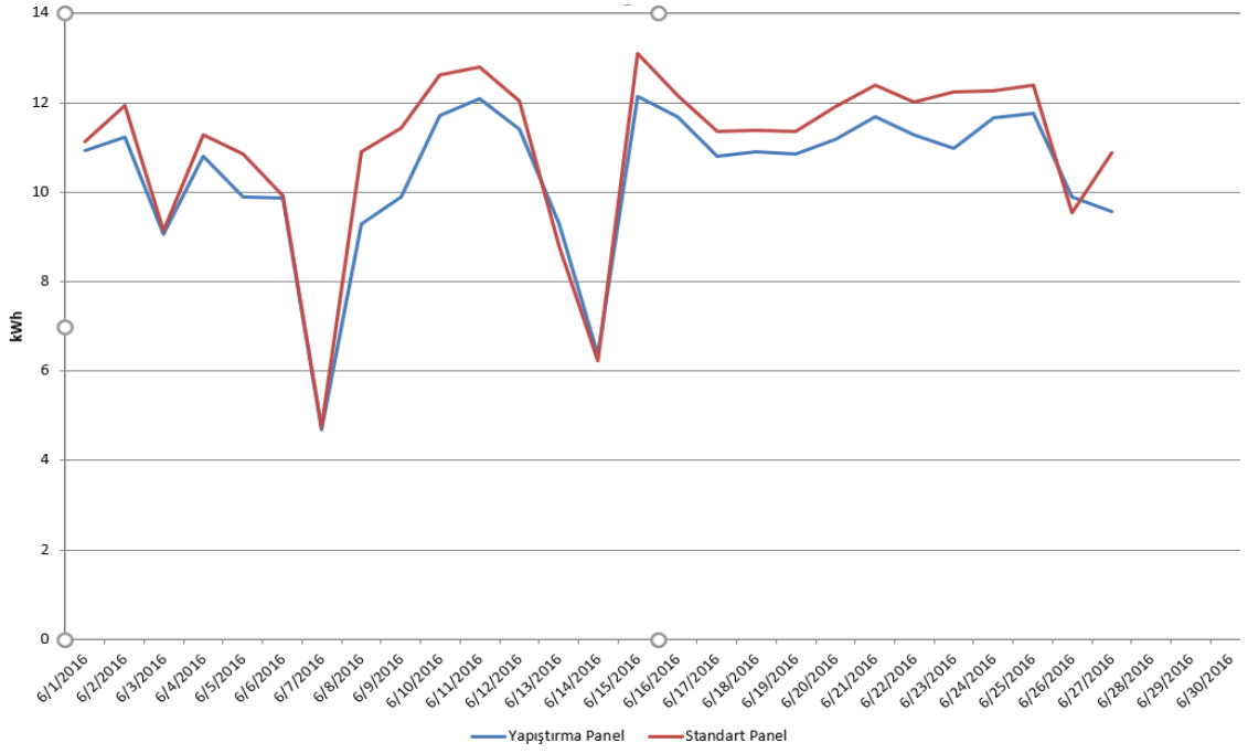
Şekil 4.15 2 kW p sistem elektrik üretimlerinin haziran ayı karşılaştırması
